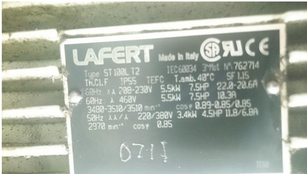
KUVA 17: Puhallusmoottorin tekninen kilpi. (Niklas Vesterinen 2015)
