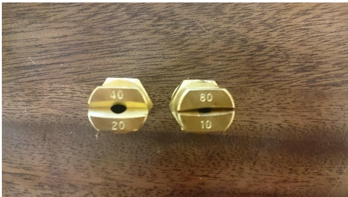
Kuva 28. FlashDry-menetelmän tutkimiseen käytettävät suuttimet. (Niklas Vesterinen 2016)
