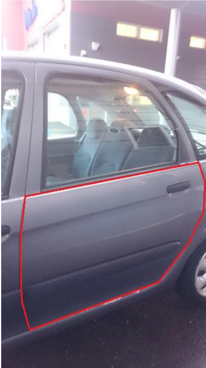
KUVA 25: Kyljen kuivuuden mittaus alue (punainen alue). (Niklas Vesterinen 2015)
