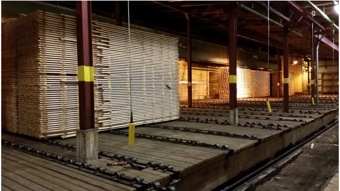
KUVA 11. Valmis rivi odottamassa kuivausta
