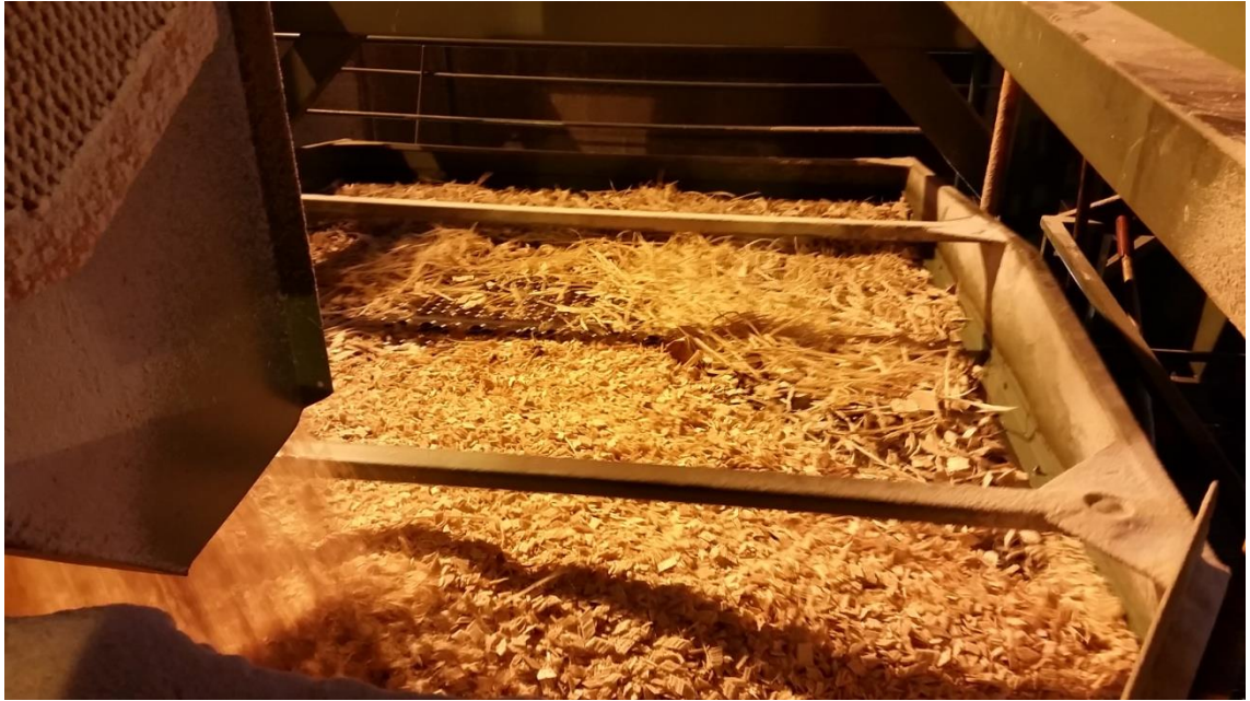
KUVA 17. Hakkeesta seulotaan puru ja hake erikseen
