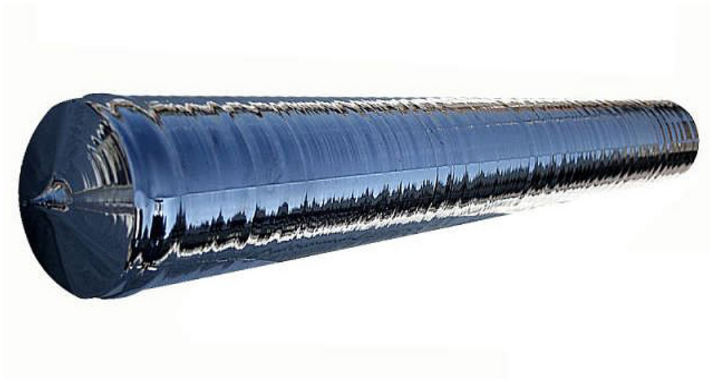
Kuva 4. Yksikiteinen piiaihio (Tindo Solar 2016)
