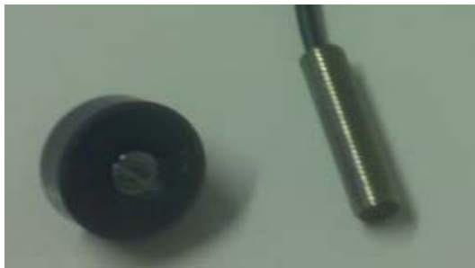
Kuva 17. Kestomagneetti ja Reed-kytkin.
