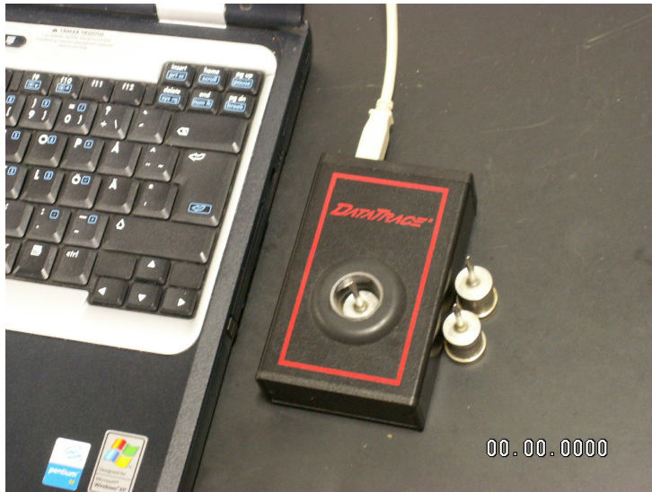
Kuva 2. Anturit ohjelmoitiin tietokoneeseen kytkettävällä telakalla infrapunaä hyödyntäen, jolloin ei tarvittu johtoja.
