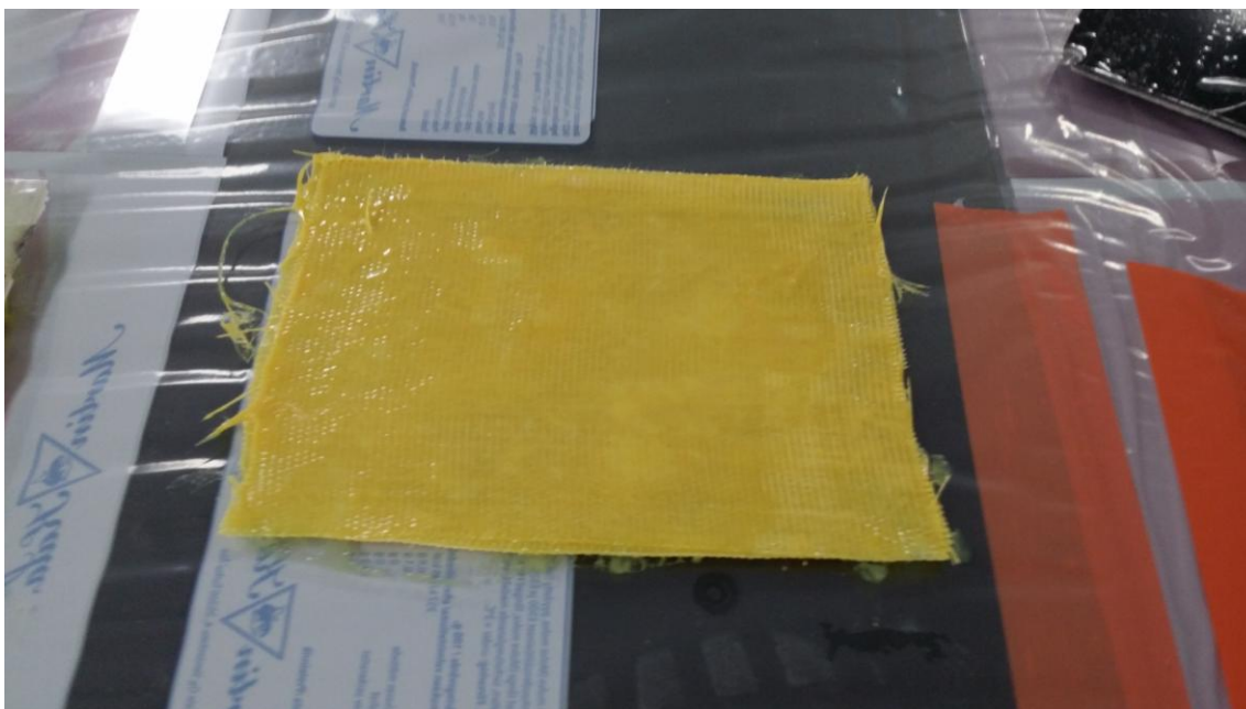
Kuva 18. Kovettumaton komposiittilaminaatti tasaisella alustalla
