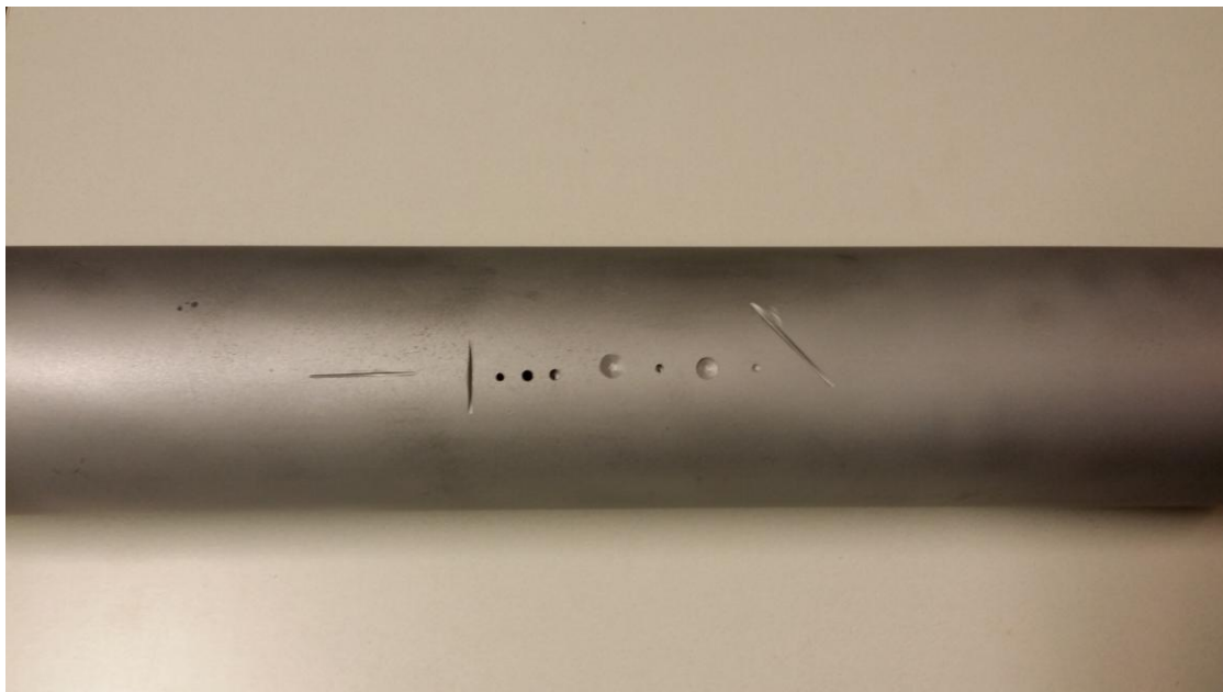
Kuva 35. Testiputki isotooppikuvausta varten lasikuulapuhalluksen jälkeen
