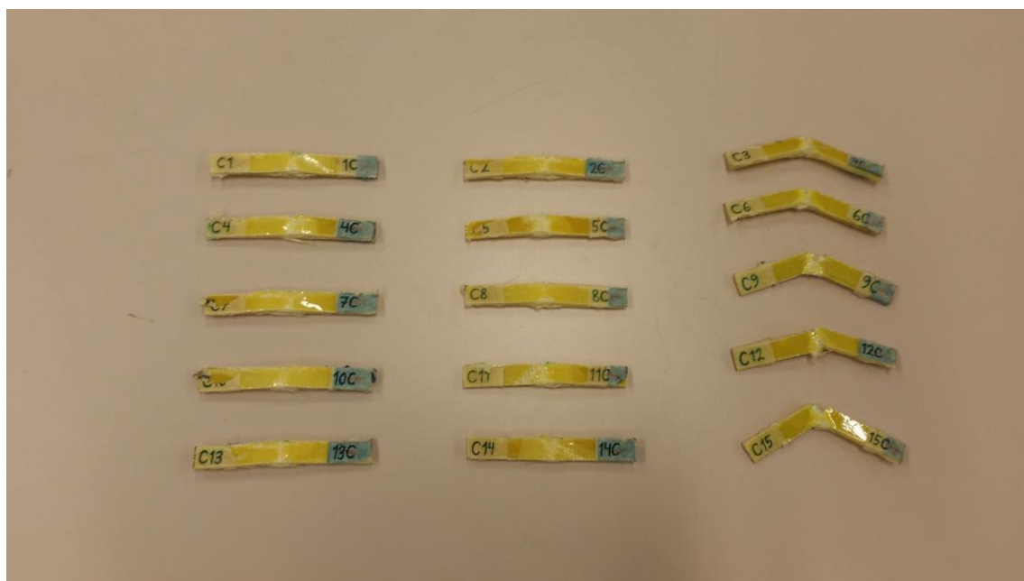
Kuva 38. Iskukoe kappaleet iskukokeen jälkeen
