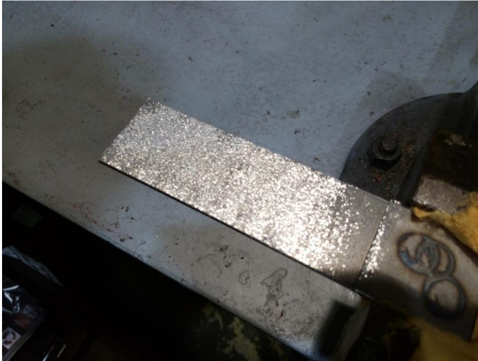
Kuva 23. Teräskappaleen pinnanlaatu Bristle Blasterilla karhentamisen jälkeen
