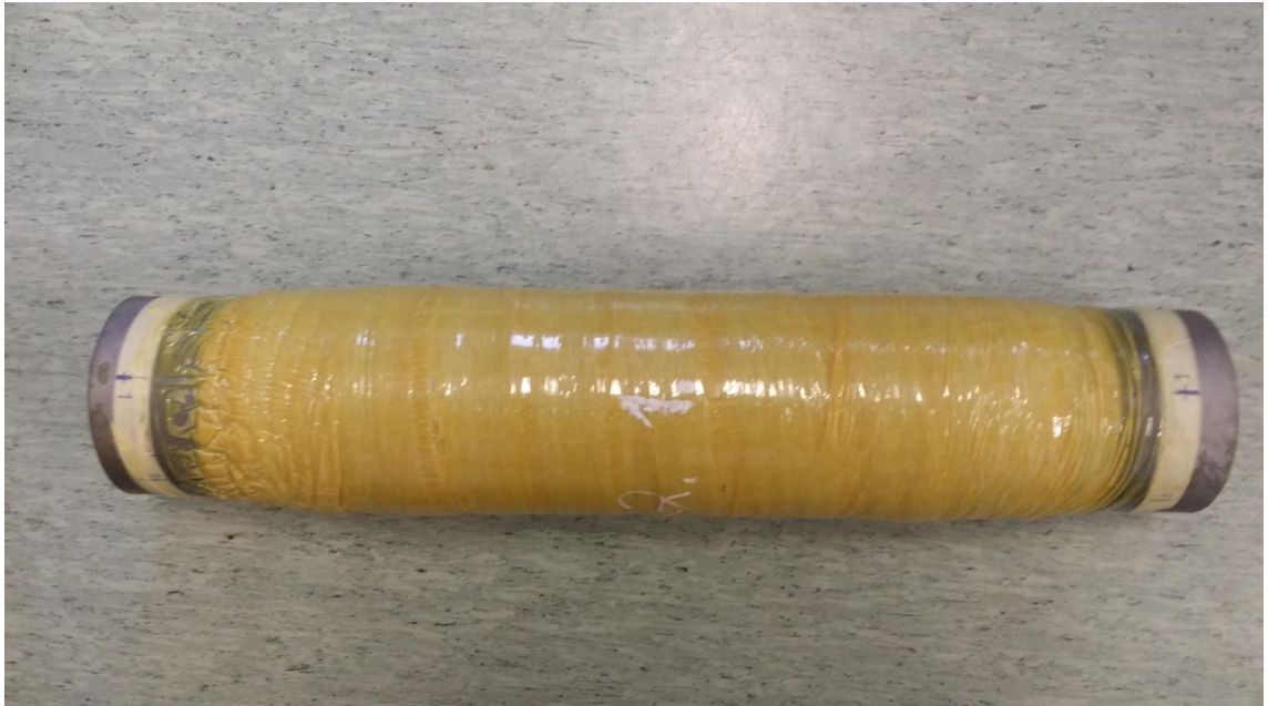
Kuva 36. Testiputki päällystettynä komposiitilla
