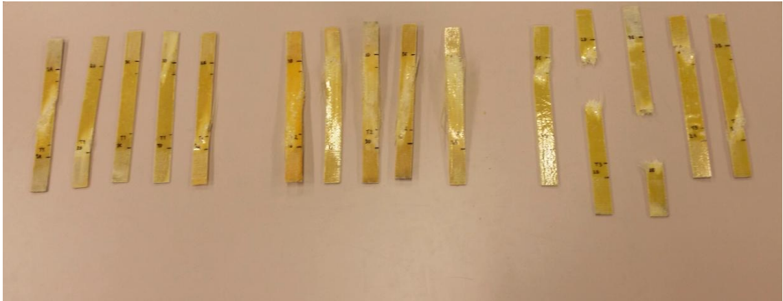
Kuva 39. Komposiittisauvat vetokokeen jälkeen
