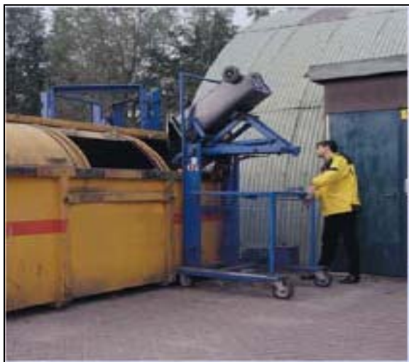
Kuva 9. Jäteastioille tarkoitetut moottorikäyttöiset nostohissit helpottavat tyhjennystä. Kuvassa Terberg Matec UK:n nostohissi [13.].
