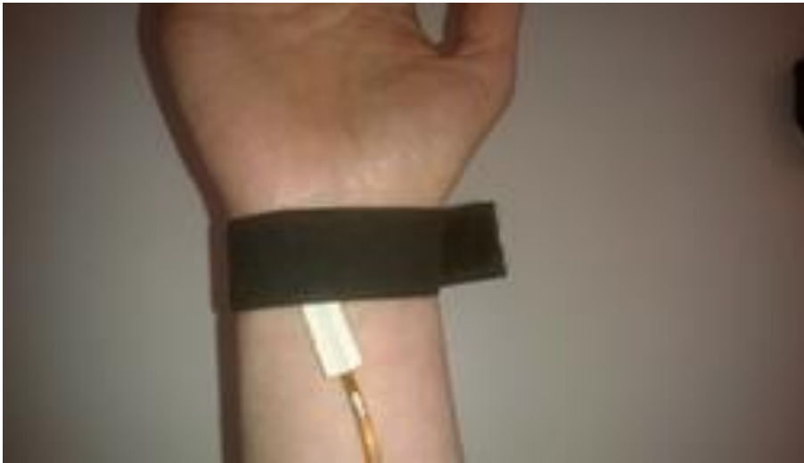
Kuva 6. Sensori kiinnitettynä ranteeseen tarranauhalla.
