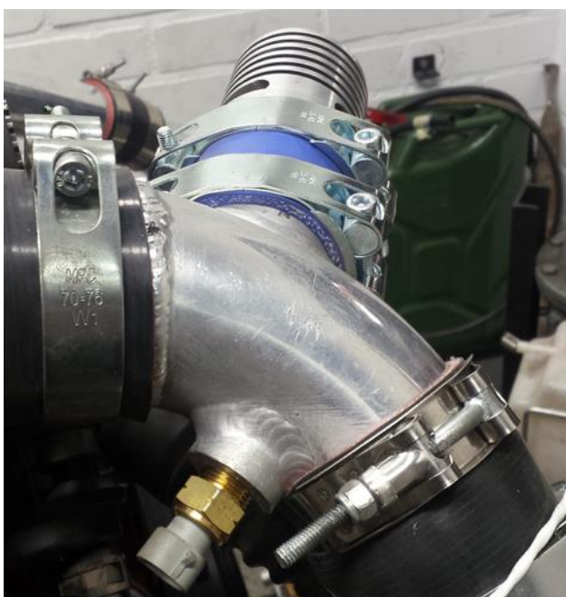
Kuva 15. Imuilman lämpötila-anturi ahtoputkessa.
