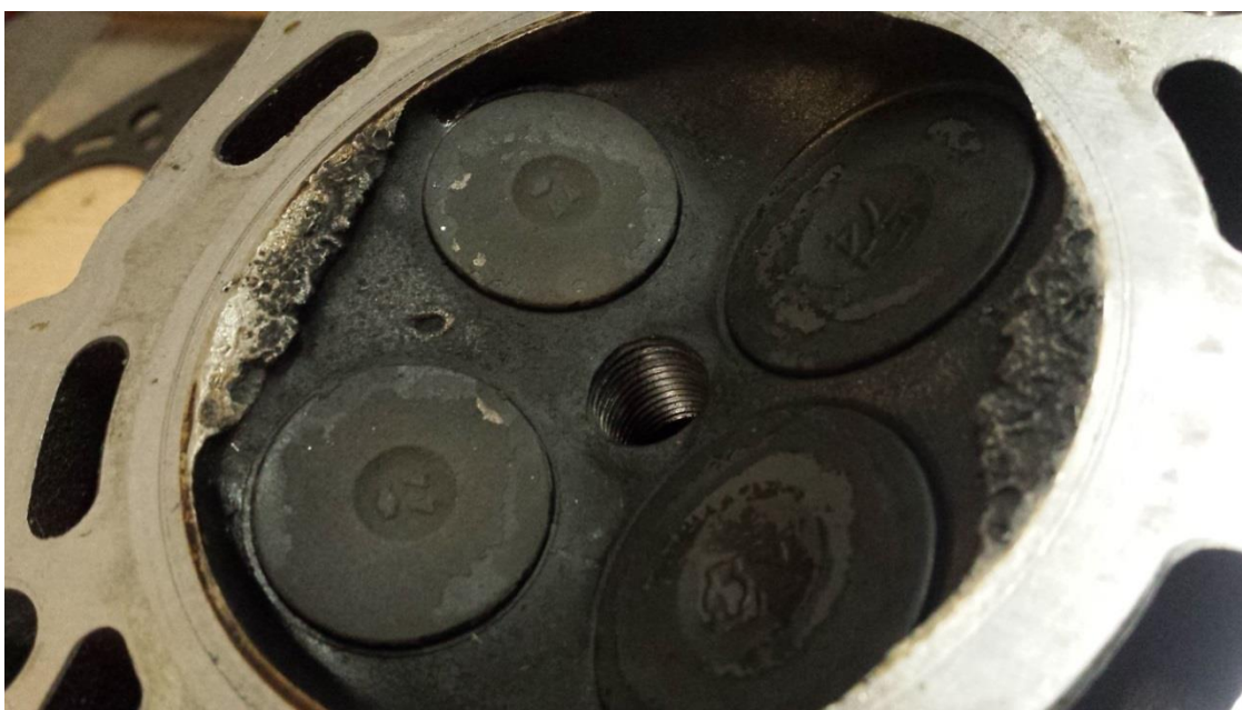
Kuva 2. Sulanut palotilan paljealue.
