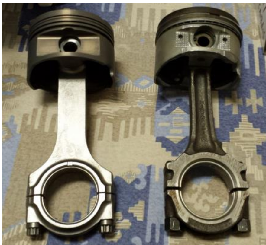
Kuva 7. Vertailussa uudet ja vanhat männät kiertokankineen.
