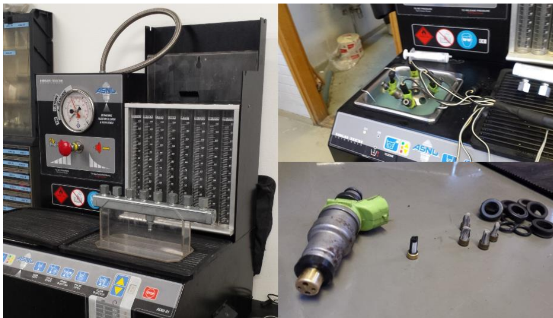
Kuva 13. Suuttimien pesu, testaus ja tiivisteiden vaihto.
