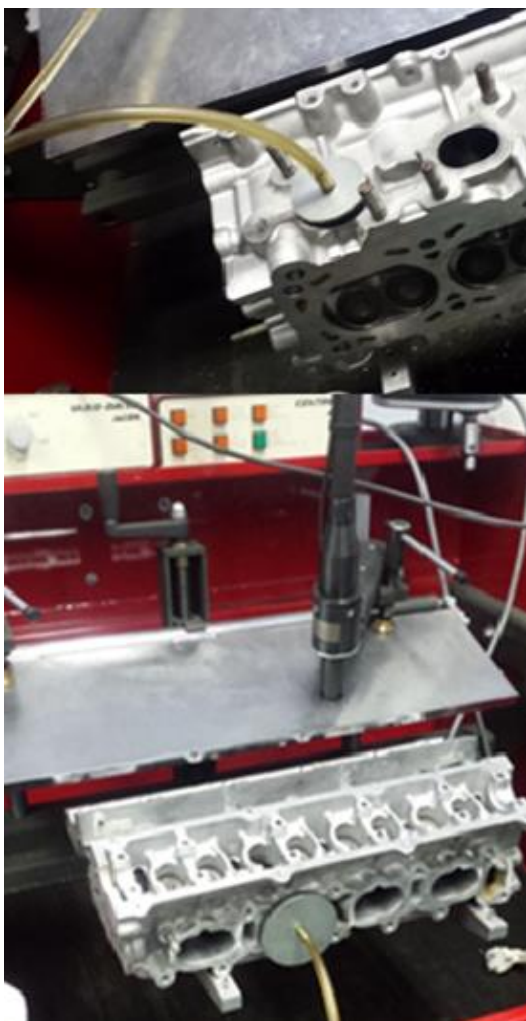
Kuva 4 Venttiilien pitävyyden testaus
