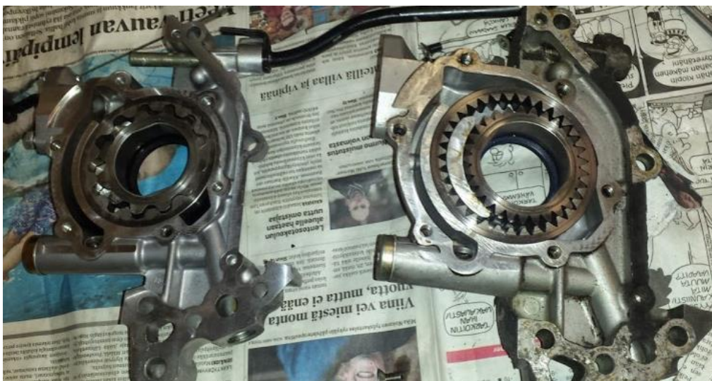
Kuva 6. Uusi ja vanha öljypumppu.
