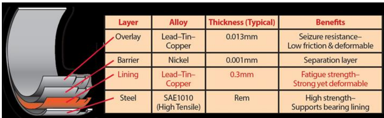
Kuvio 7. Acl monikerrosmetallilaakerin rakenne (Acl performance 2015).
