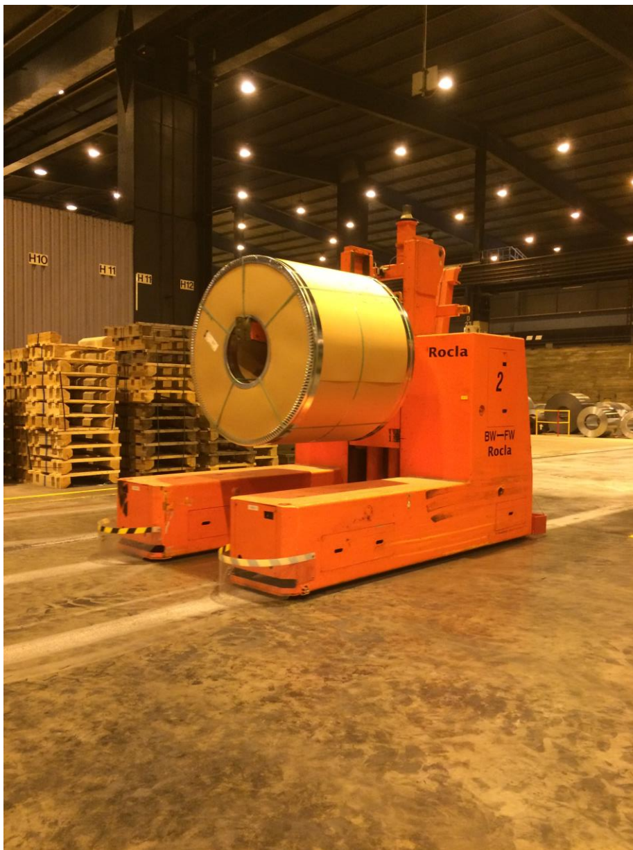
Kuva 7. VIHI-LRHQ-300163 suorittamassa teräskelan siirtoa.
