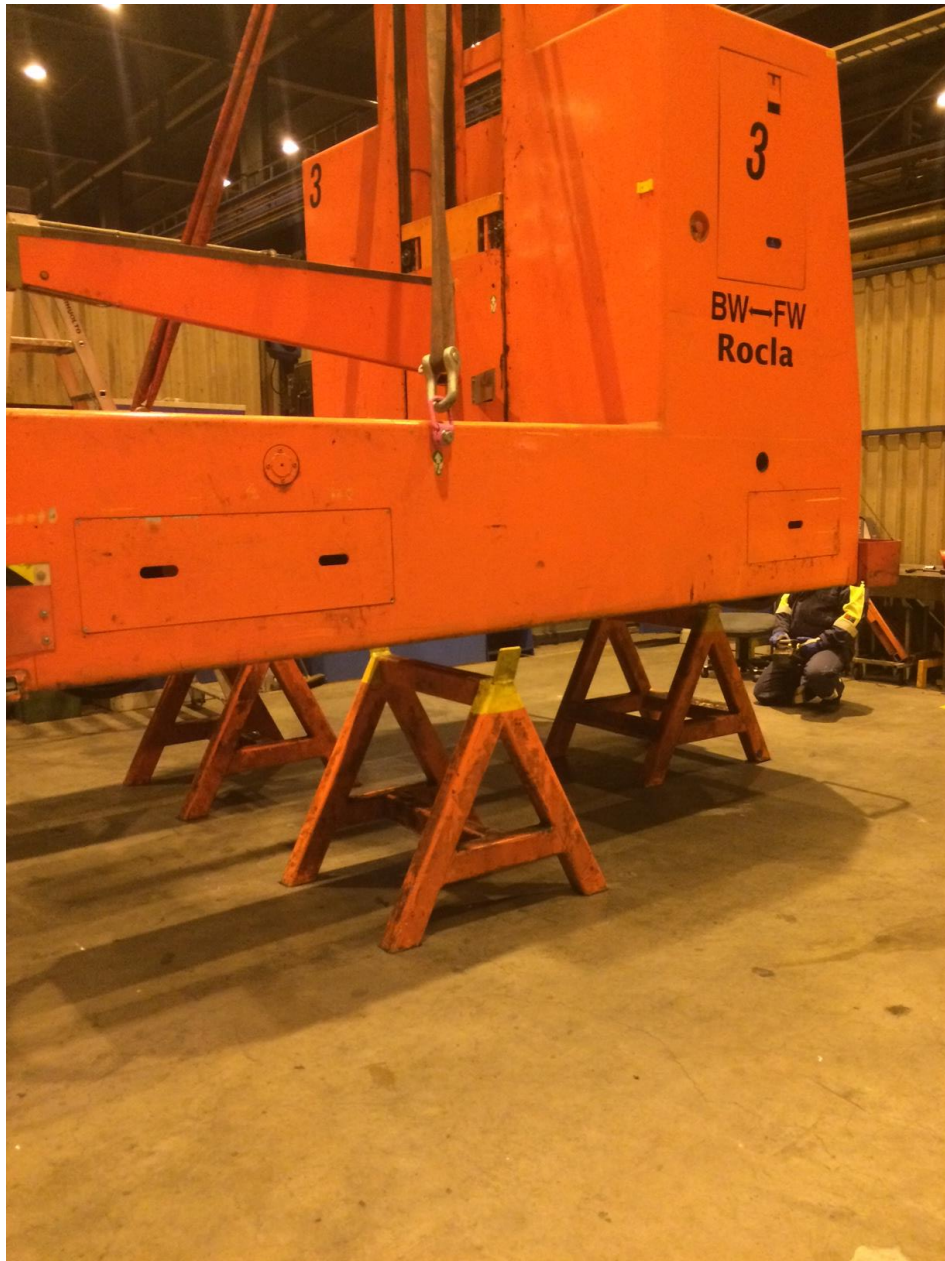
Kuva 8. Vihivaunu 3 nostettavana huoltopukkien päälle.
