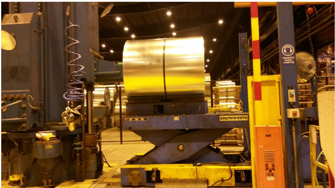
Kuva 5. Sinkityslinja 3:n loppupään kelavaunu siirtämässä kelaa kääntöristille.
