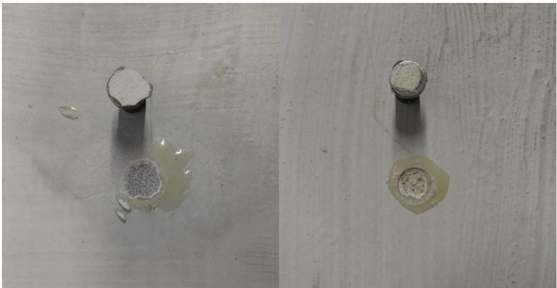
Kuva 17. Carbolinen (vas.) ja Bronyan irtivetokoenäyte
