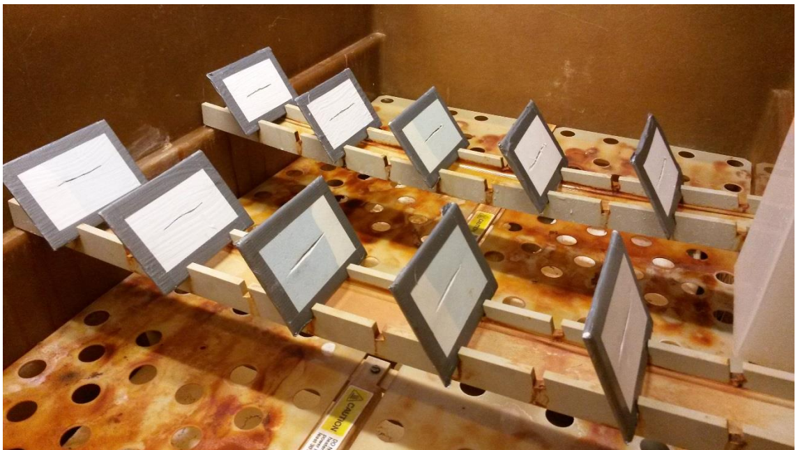
Kuva 7. Reunoista ja taustoista teipillä suojatut näytteet suolasumukaapissa ennen testin aloitusta
