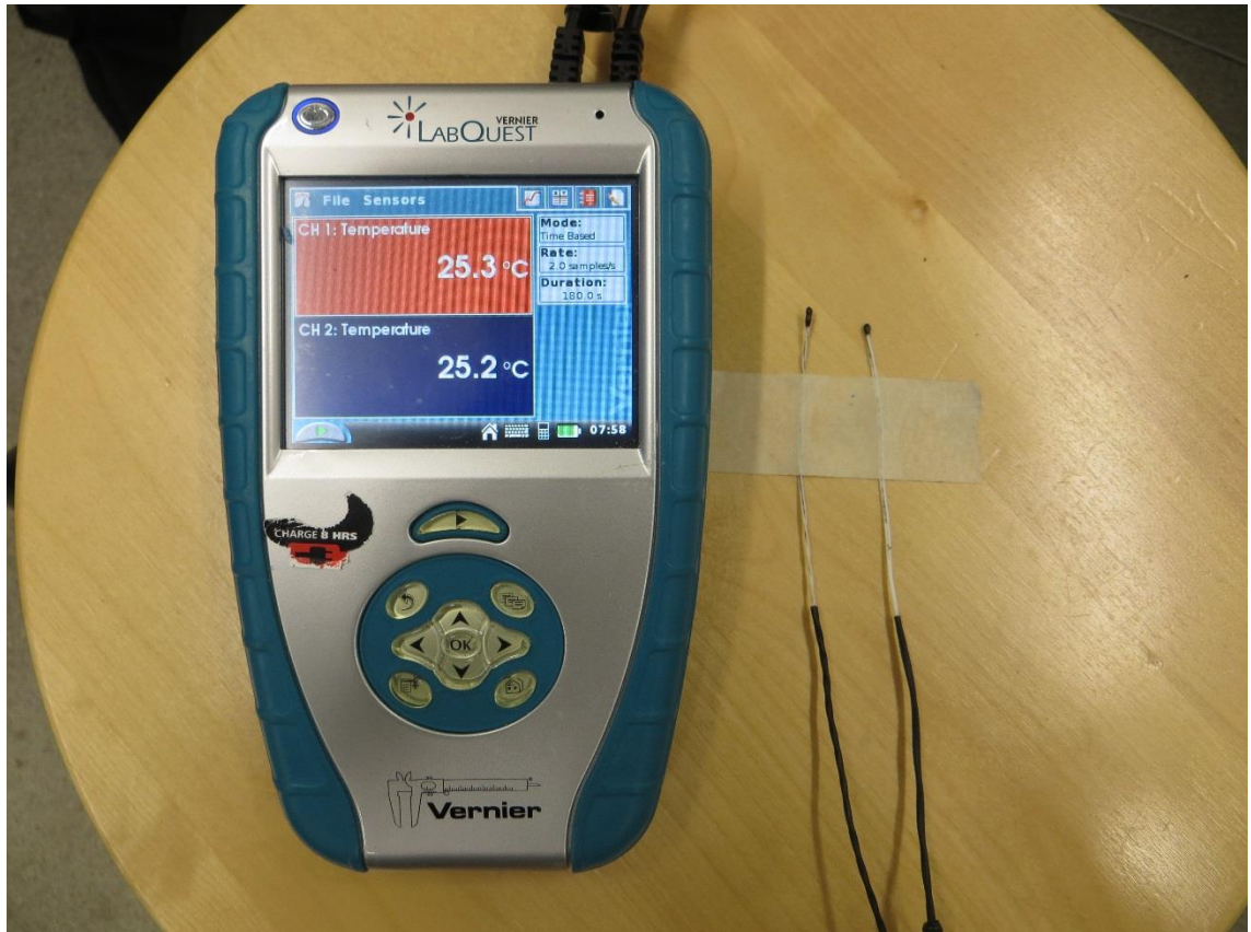
Kuva 11. Vernier Labquest -datankeräyslaite ja siihen kytketyt kaksi pintalämpötila-anturia, jotka kiinnitetään mitattavaan pintaan teipillä.
