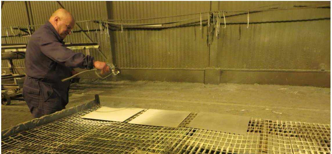
Kuva 5. Bronya Facade -lämmöneristysmaalin levitystä korkeapaineruiskulla
