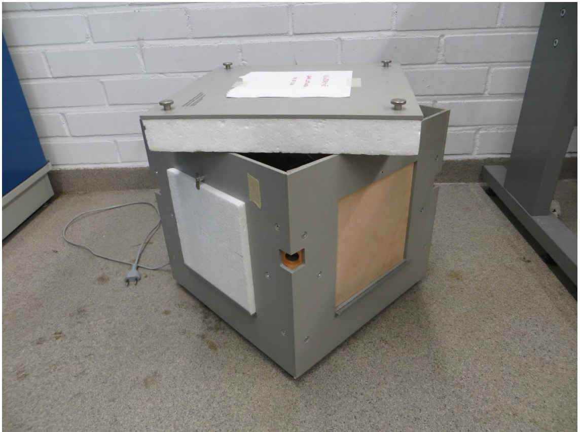
Kuva 10. Eristysolosuhdelaatikko Phywe High insulation house, 04507.93
