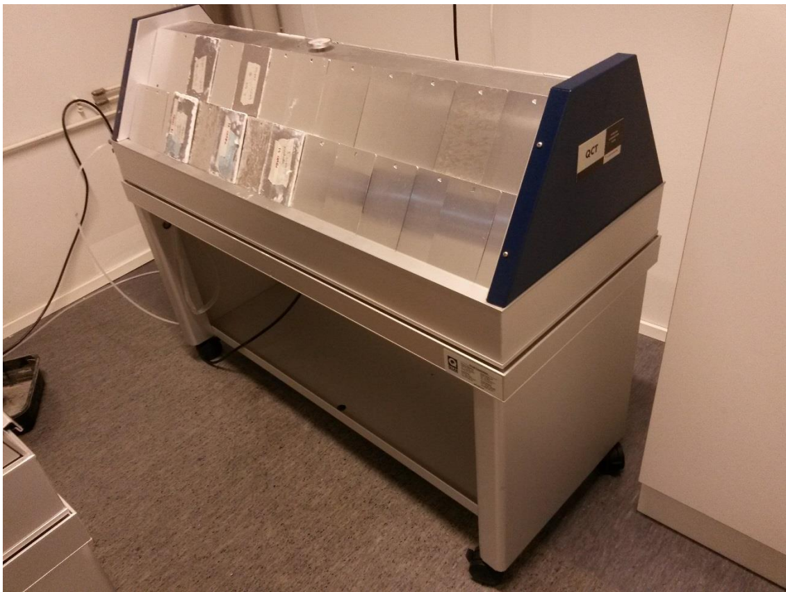
Kuva 8. Kondensaatiotestilaite QCT Cleveland Condensation Tester
