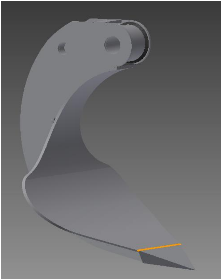
KUVA 3. Valmis kouran leuan 3D-malli.
