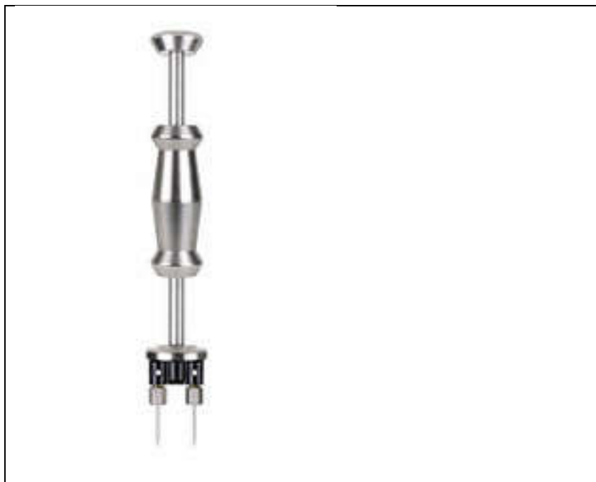
Kuva 11. Gann-merkkinen puun painoprosentti-mittalaite.
