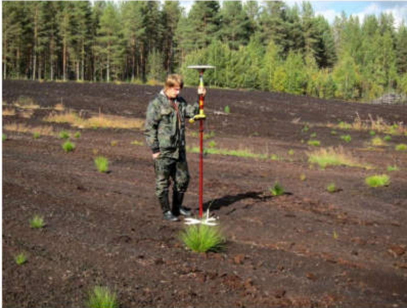
Kuva 4. Koordinaattien mittaamista signaloidulle tukipisteelle satelliittimittauskalustolla [6].
