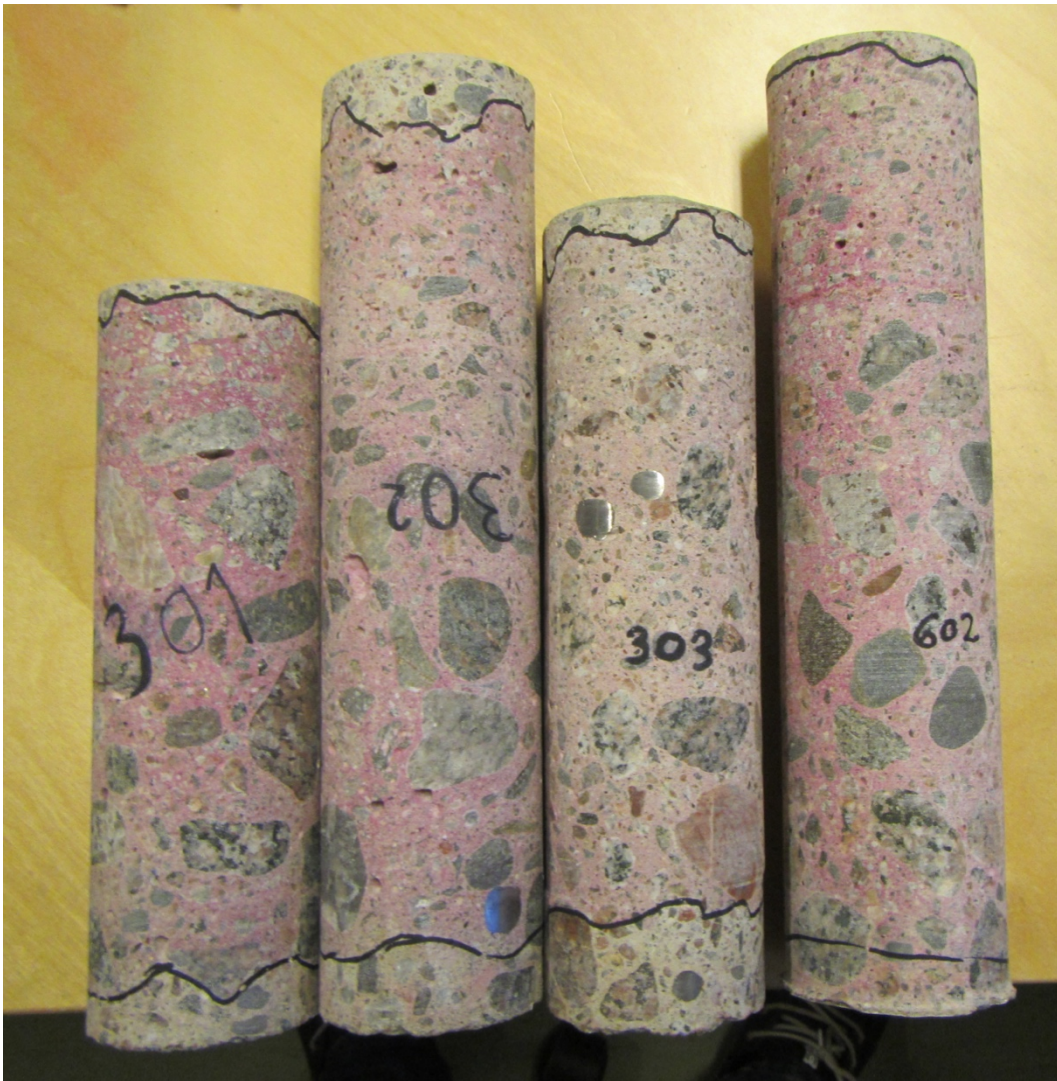
Kuva 11. Parvekelaatoista irrotetut näytteet.
