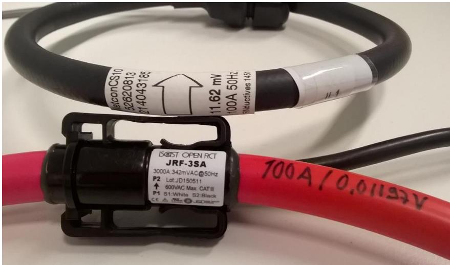
Kuva 16. Sensoreihin merkatut kalibrointikertoimet ja suuntanuolet
