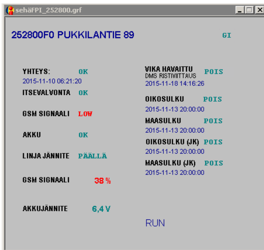
Kuva 37. Ilmajohdoverkon vikaindikaattorin asemakuva
