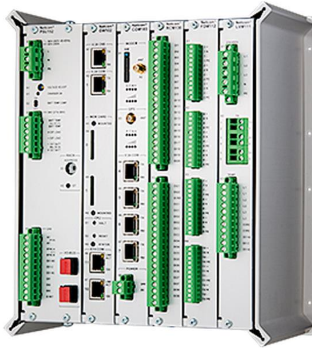
Kuva 15. Netcon 100 kaukokäyttölaite (Netcontrol 2015)
