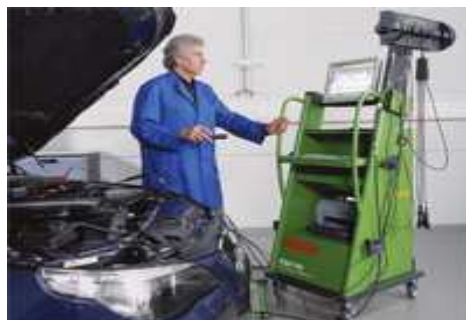
KUVIO 2. PICO-oskilloskooppi ja Bosch FSA-järjestelmätesteri
