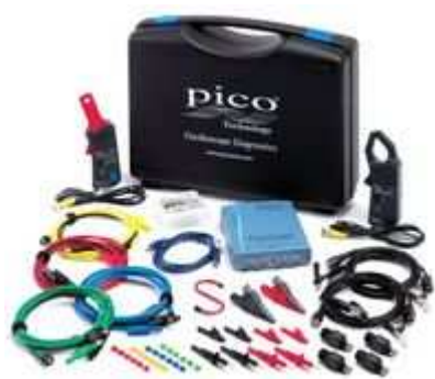
KUVIO 2. PICO-oskilloskooppi ja Bosch FSA-järjestelmätesteri
