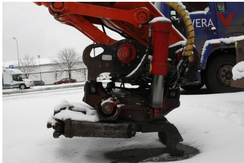
KUVA 6. Indexator Rototilt -työväline kiinnitettynä Hitachi -kaivinkoneen puomiin
