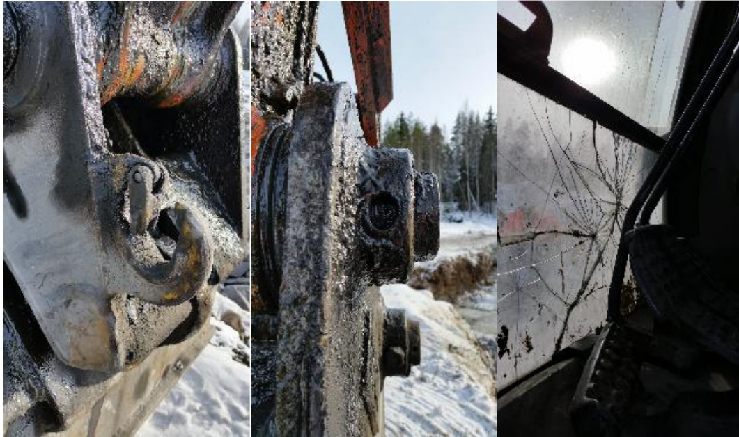
Nostokoukun lukitus rikki Niveltapin lukitus puuttuu Tuulilasi Rikki
