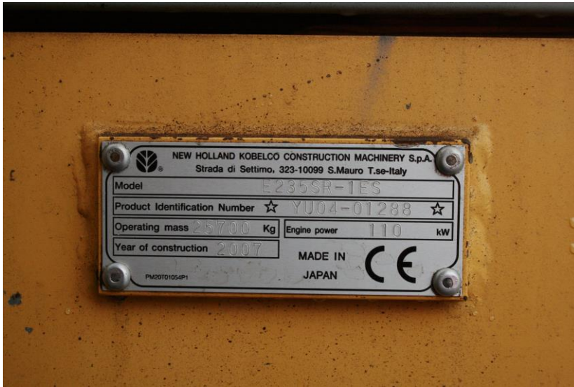
KUVA 7. New Holland- merkkisen kaivinkoneen tyyppikilpi
