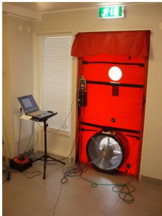
Kuva 2. Ilmanpitävyyden mittaus ”puhallusovi” -kokeella. (Technobothnia.)
