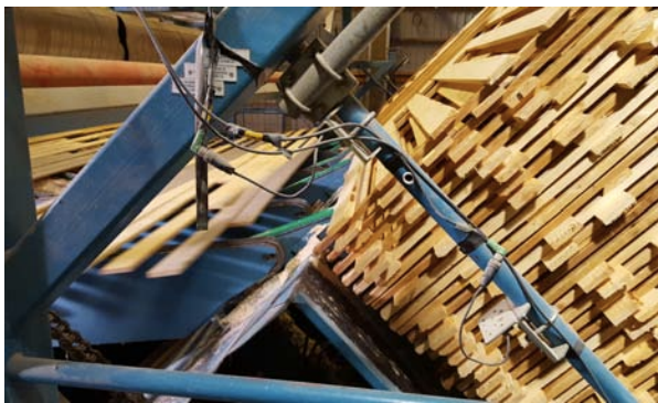
KUVA 8. Kuivauksesta tullut kuorma purettavana tasaamon purkulaitteessa.
