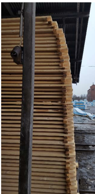
KUVA 12. Yläosasta lievästi liikkunut rimakuorma.
