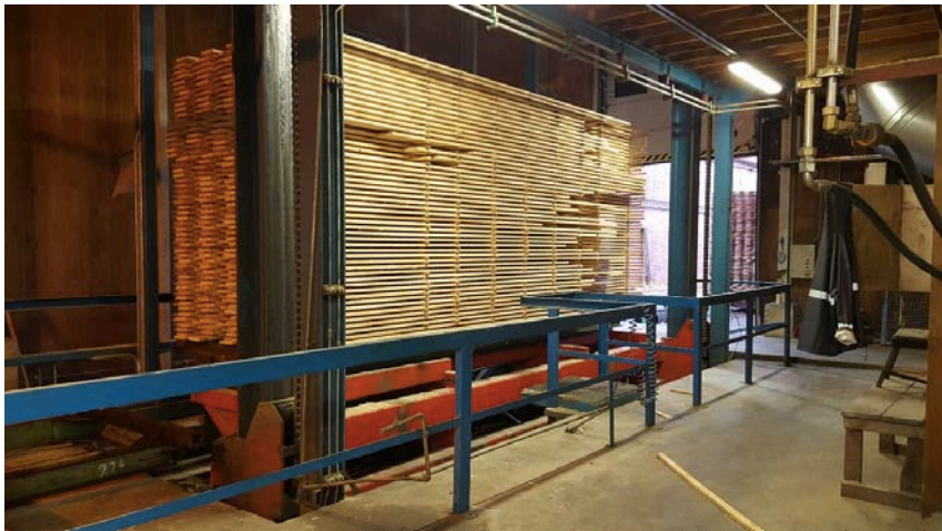
KUVA 3. Rimoitettu lautakuorma eli rimakuorma hississä.
