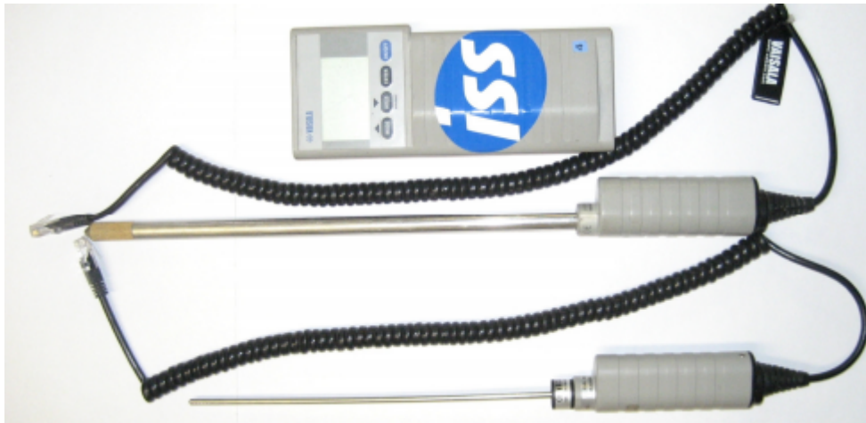
KUVA 9. Vaisala HMI41-Mittalaite, HMP42 ja HMP46-Mittapäät (Koivisto, 2007,30)
