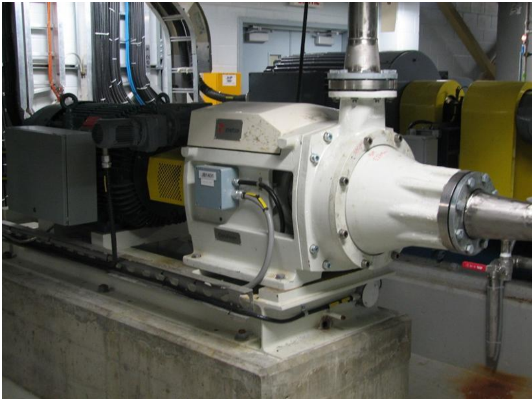
KUVA 7. Valmet OptiFiner RF 0 -jauhin asennettuna teräspedille. (Innofibre, 2015)
