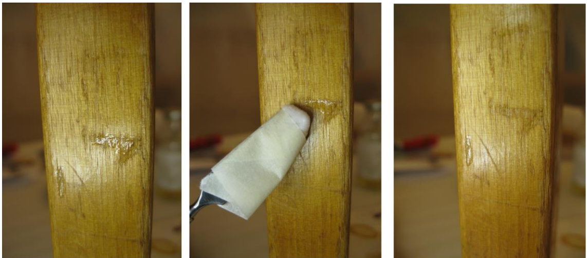
Kuva 22. a, b ja c. Alkuperäisestä lakkapinnasta erottuva kiiltävä Laropal A81®, ihmiesienellä hankaus ja kiillon sulautuminen ympäröivään pintaan.
