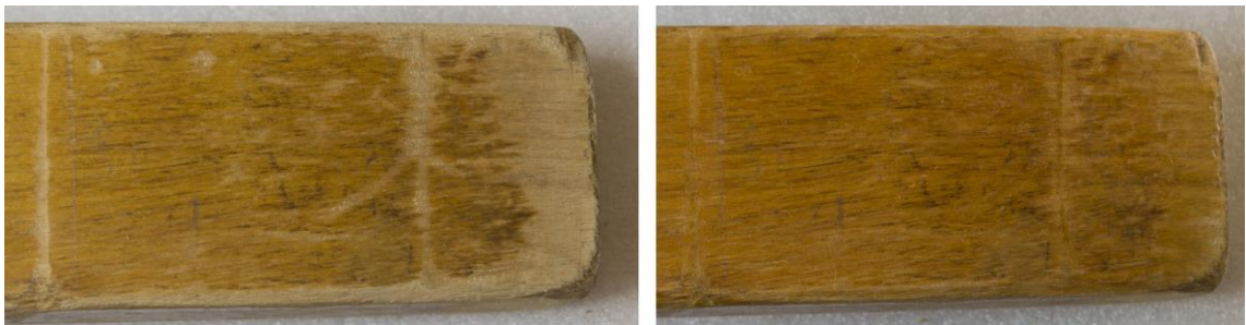
Kuva 23. a ja b Vasemmalla tuolin jalka puhdistettuna ja oikealla sama jalka retusoinnin jälkeen.
