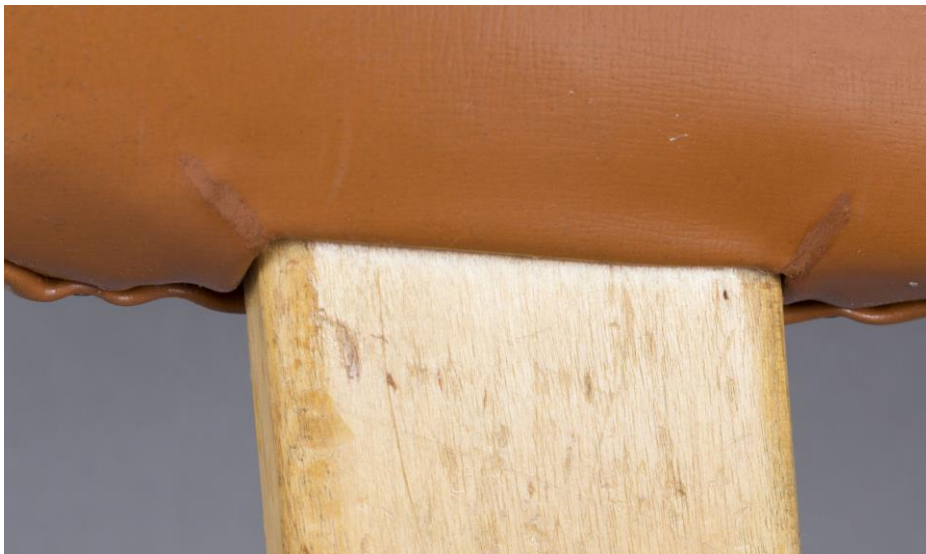
Kuva 28. Keinoahan repeämät paikattiin Reemay®-tukikankaalla sekä Laropal® A81 ja onttojen lasipallojen seoksella, ja retusointiin käytettiin akryylivärejä.
