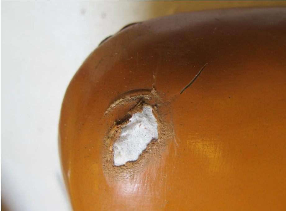
Kuva 25. Keinonahassa olevaa aukkoa hieman suurempi pala Reemay®-kuitukangasta ujutettiin keinonahan alle.
