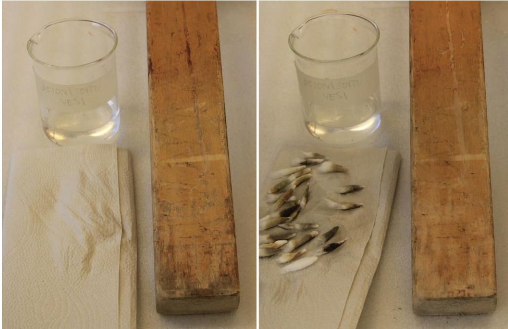
Kuva 20. a ja b. Tuolin jalka ennen puhdistusta vasemmalla ja deionisoidulla vedellä puhdistamisen jälkeen oikealla.
