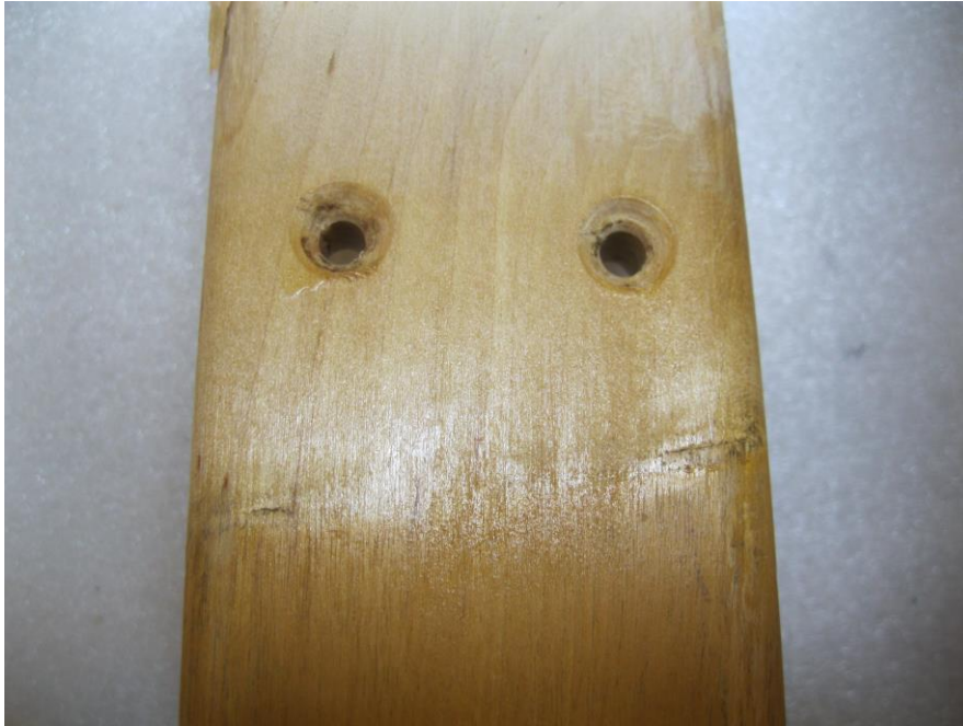
Kuva 4. Hartialaudan alla suojassa ollut pystypuu; yläosassa käsittelemätön puu, keskellä valolta ja kulutukselta suojassa ollut lakattu pinta ja alhaalla kellastunut ja kulunut lakkapinta.
