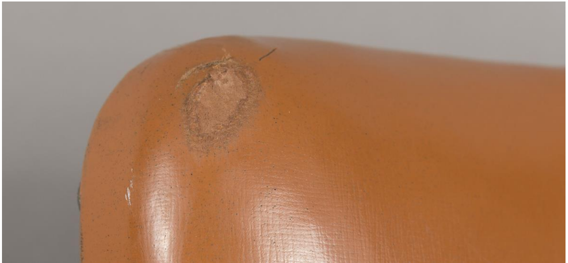
Kuva 26. Paraloid B72:sta, lasipalloista ja kuivapigmenteistä tehty paikkausmassa sulautui hyvin keino- nahan vaurioituneeseen pintaan.
