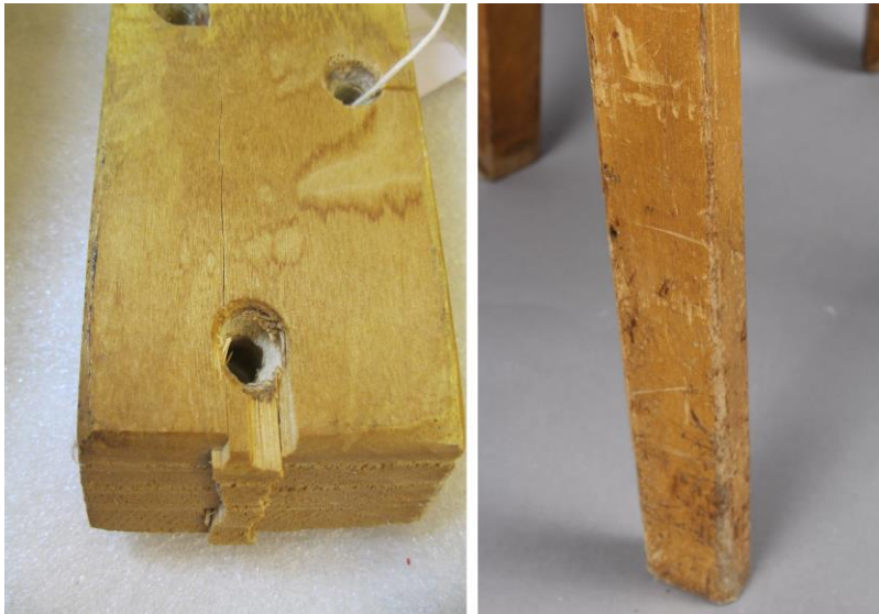
Kuva 3. Oikeasta takajalasta lohjennut puu ja tuolin jalkojen vauriot.
