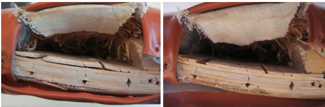
Kuva 19. Hartialaudan osittain avatun verhoilun alta paljastunut vanerin vaurio vasemmalla ja liimattuna oikealla.
