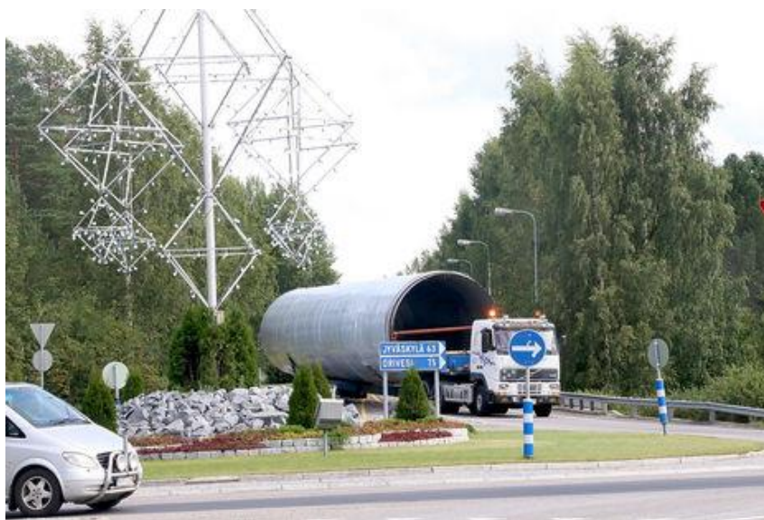
Kuvio 4. Havainnointikuva erikoiskuljetuksen vaatimasta kääntymistilasta. Kuljetuksen leveys neljä metriä ja pituus 34 metriä. (Suur-Keuruu 2015. Kuva: Markku Piilemä).
