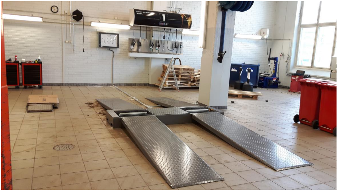
KUVA 13. Uusi pinta-asennettu jarrudynamometri toimintavalmiudessa (Kuva: Kari Sukanen 2016)
