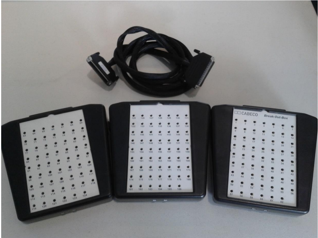
Kuva 8 Break out box mittataulut ja kaapeli, jolla ne yhdistetään haaroitusosaan
