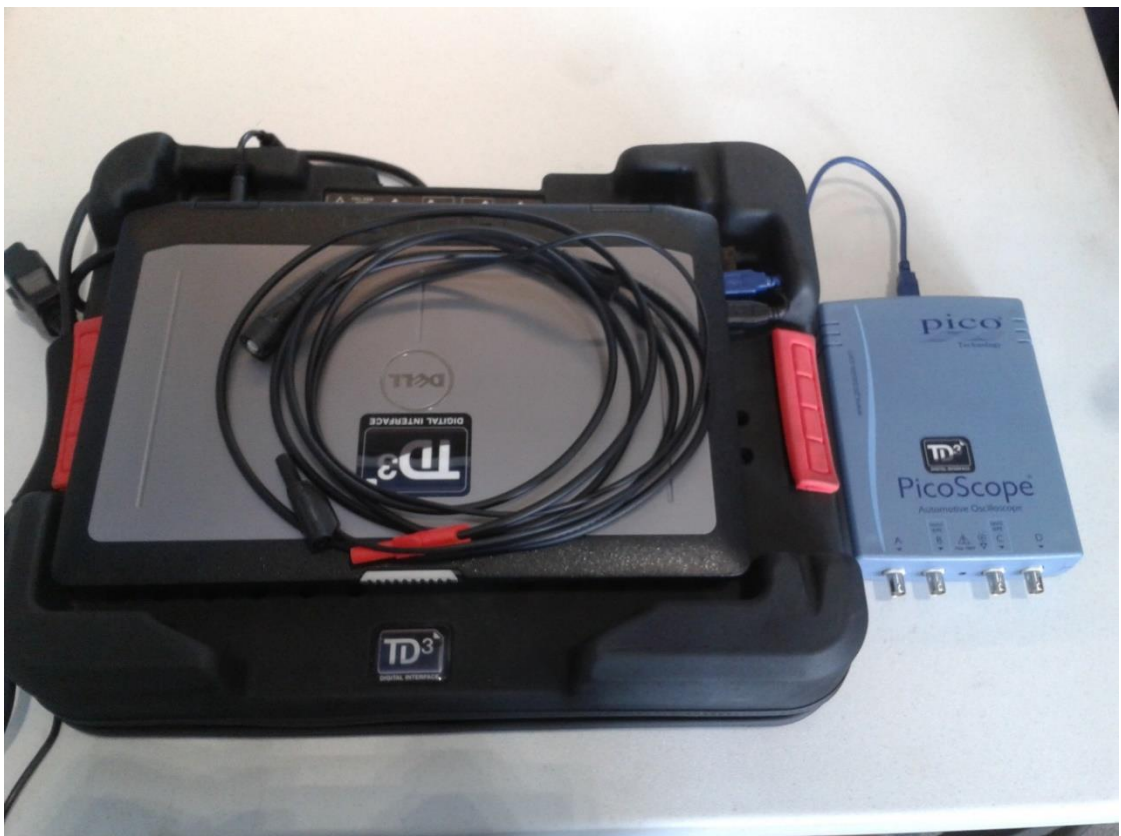
Kuva 11. PC-oskilloskooppi ja sen mittausjohto, joka liitetään oskilloskooppi moduuliin oikealla
