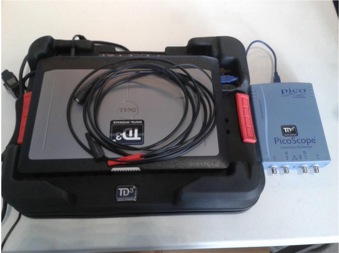
Kuva 1. PC–oskilloskooppi ja oskilloskooppimoduuli oikealla, jossa 4 kpl mittakana- via
