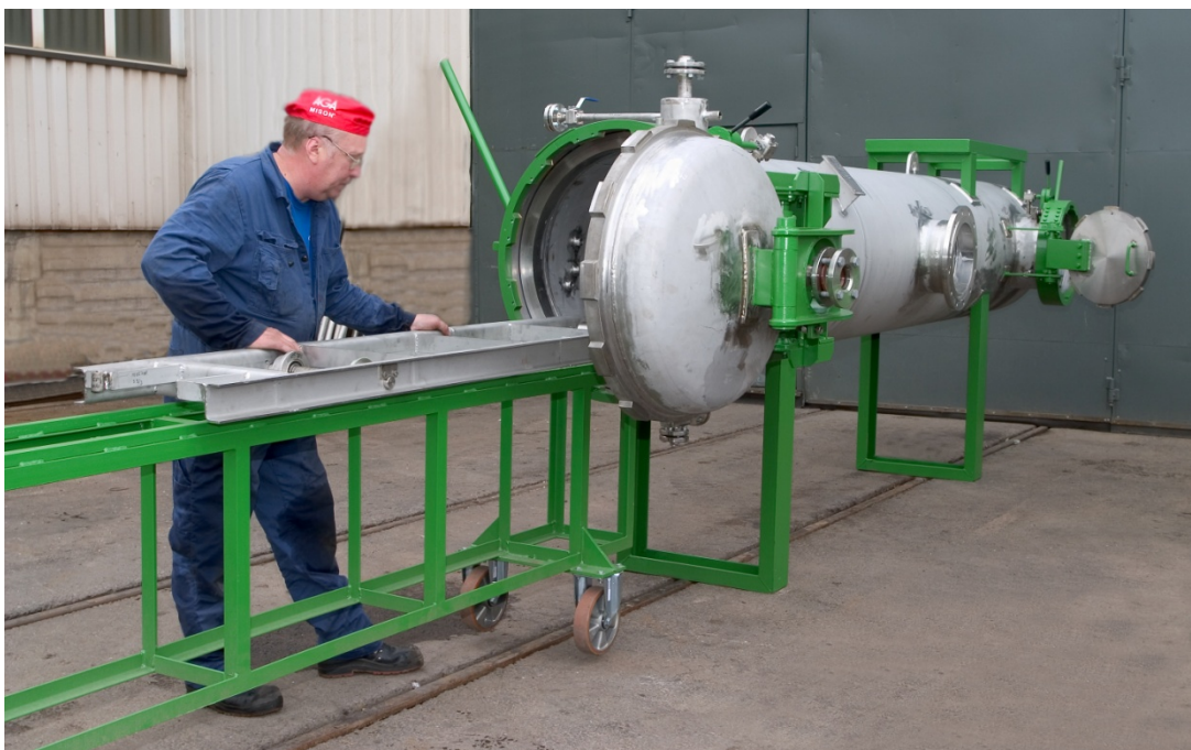
Kuva 7. Vaunukiskot ja liikuteltava apupöytä.
