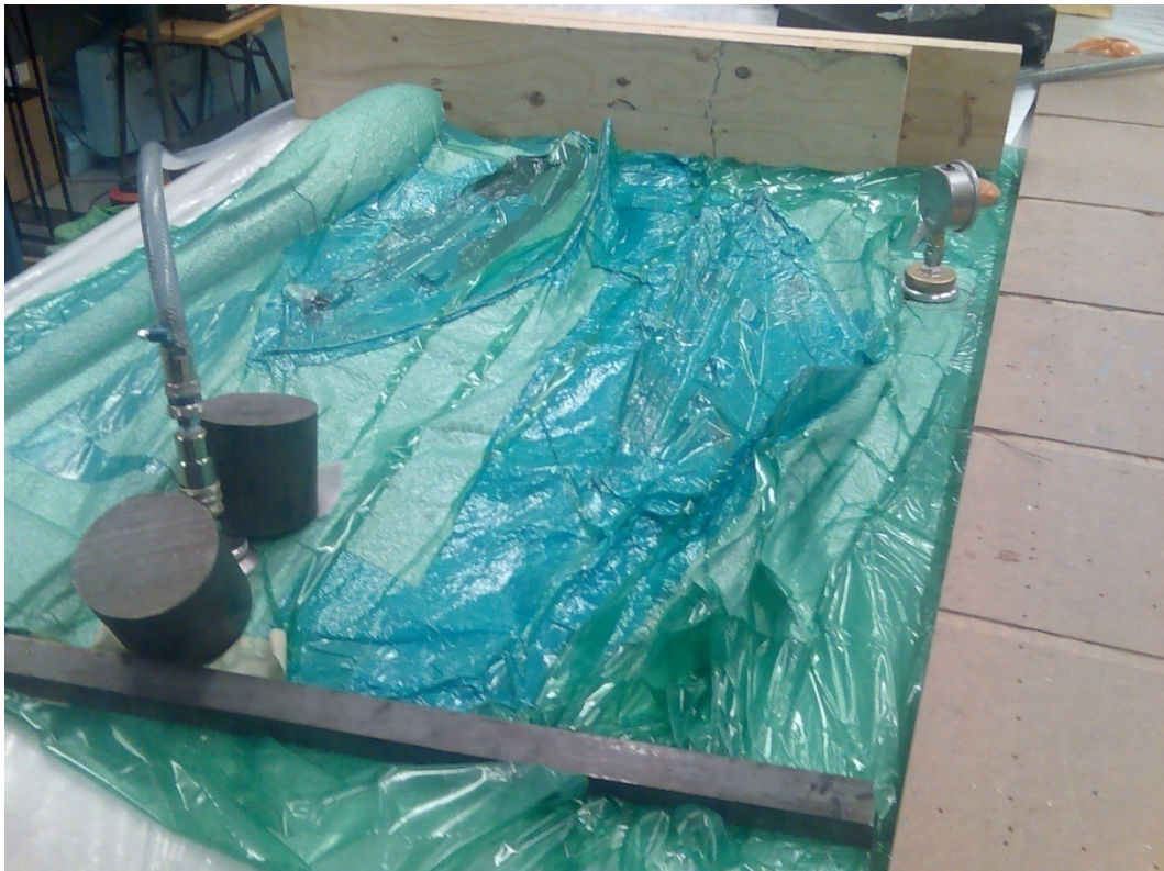
Kuva 3. Kolme muottia alipainesäkissä.
