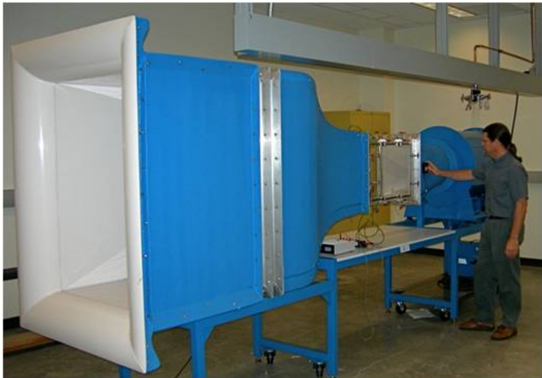
Kuva 22. Avoin pöytämallinen tuulitunneli
