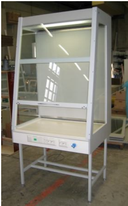
Kuva 12. Vetokaappi haihtuvien nesteiden käsittelyyn.
