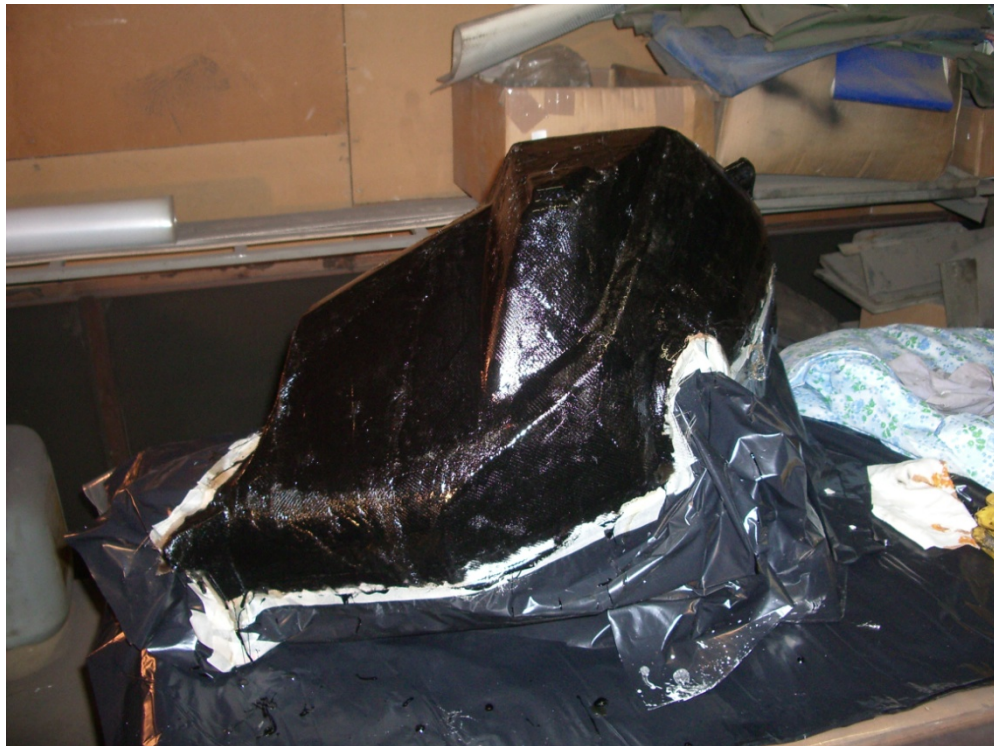
Kuva 2. Avolaminointi, urosmaster + musta gelcoat + 2 kerrosta 300g/m 2 lasikuitumattoa + polyesterihartsia.
