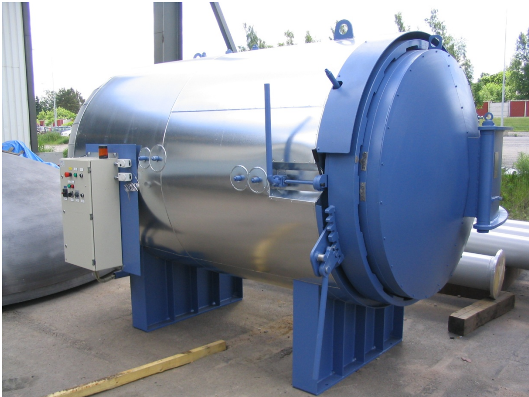
Kuva 6. Autoklaavi halkaisijaltaan 1500 mm.
