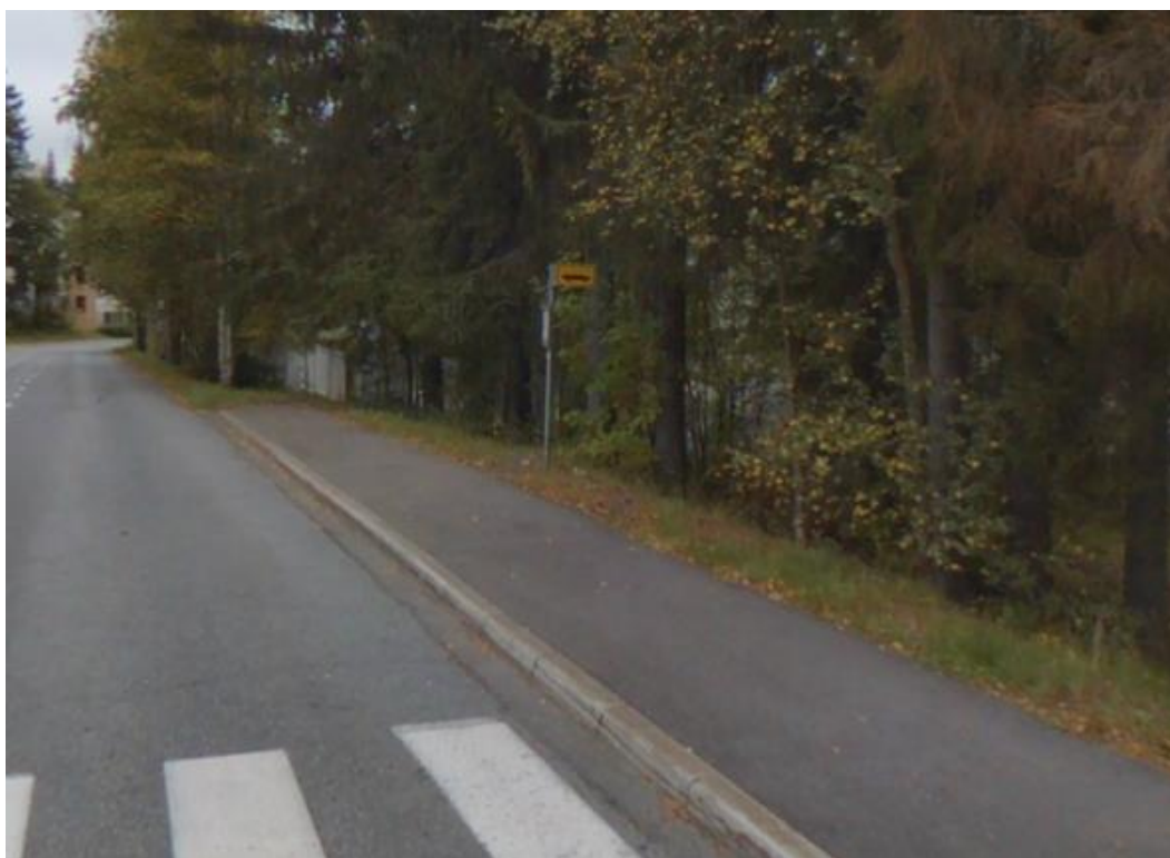
Kuva 23. Suunnistajanpuisto pysäkiltä on nousijoita 61,1/vrk. Tilaa katoksen rakentamiselle on, mutta pysäkiltä lähtevä pitkä luiska aiheuttaa normaalia enemmän maanrakennustöitä. (Globe Spotter 2016)
