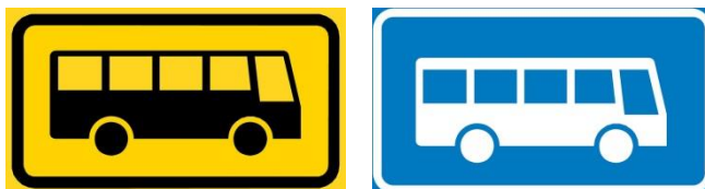
KUVA 1. Paikallisliikenteen pysäkit merkitään vasemmanpuoleisella 531 merkillä ja kaukoliikenteen pysäkit oikeanpuoleisella 532 merkeillä. (Tieliikenneasetus 328/1994 3:20 §)
