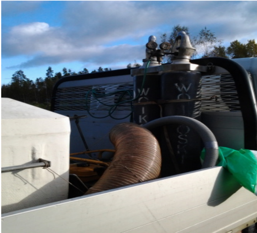
Kuvio 14. Kalanpoikasten kuljetusauton happisäiliövarustus
