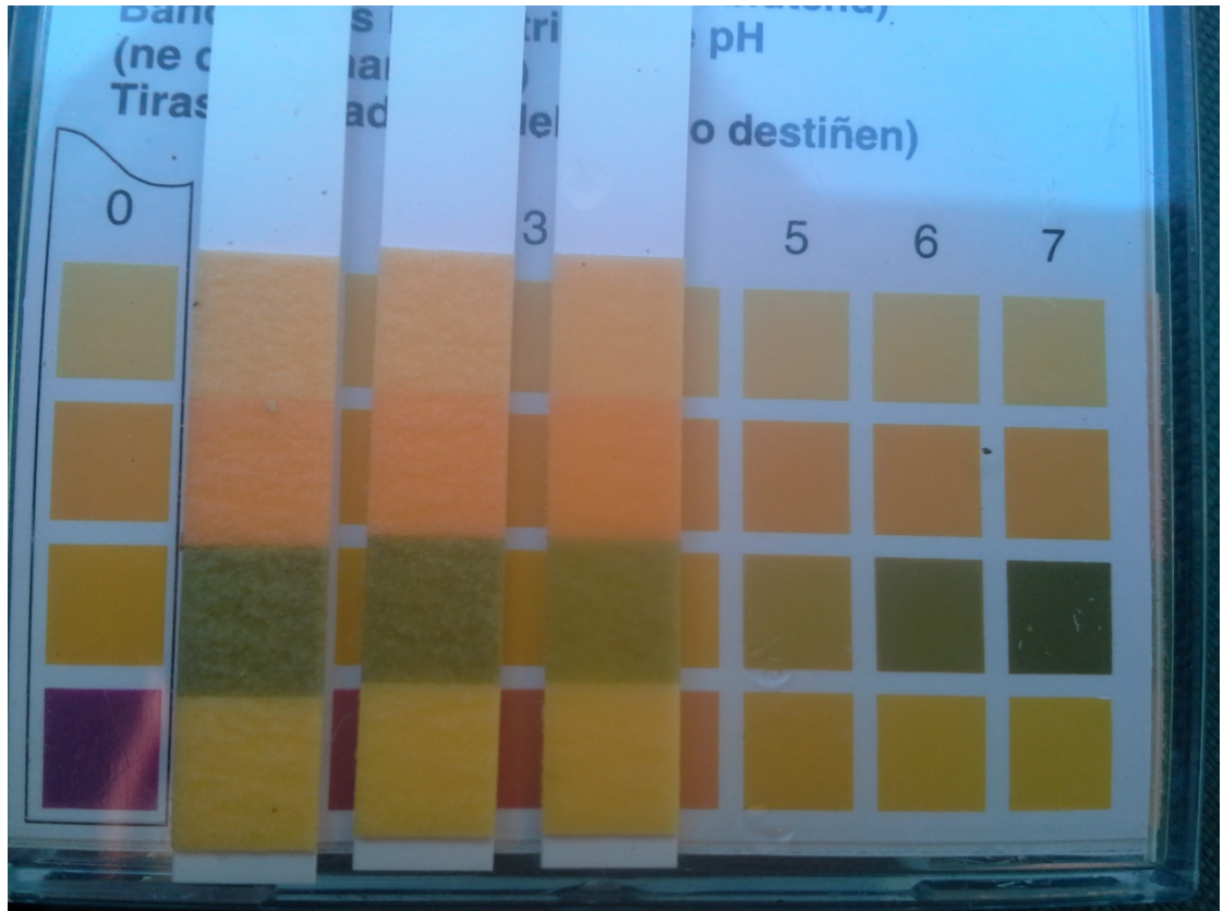
Kuvio 15. pH-mittauksen indikaattoriliuskat
