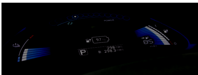
Kuva 7. Nissan Leaf -sähköauton mittaristo. Ohut oikean puoleisin palkki kertoo akun kapasiteetin. [30]
