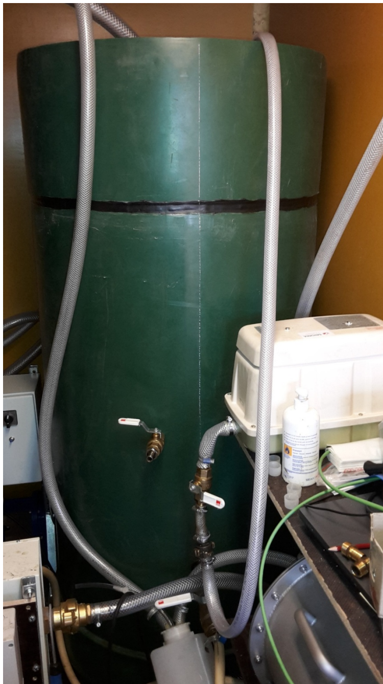
Kuva 11. Pilotoinnin ilmastusallas (Torvinen, 2016)
