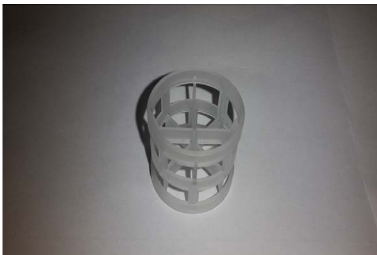
Kuva 9. Muovinen täytekkappale (Torvinen, 2016)
