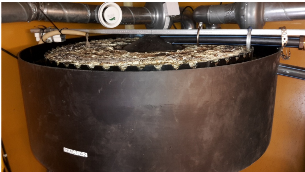
Kuva 15. Kaasu-neste-kiinteä -erotin (Torvinen, 2016)
