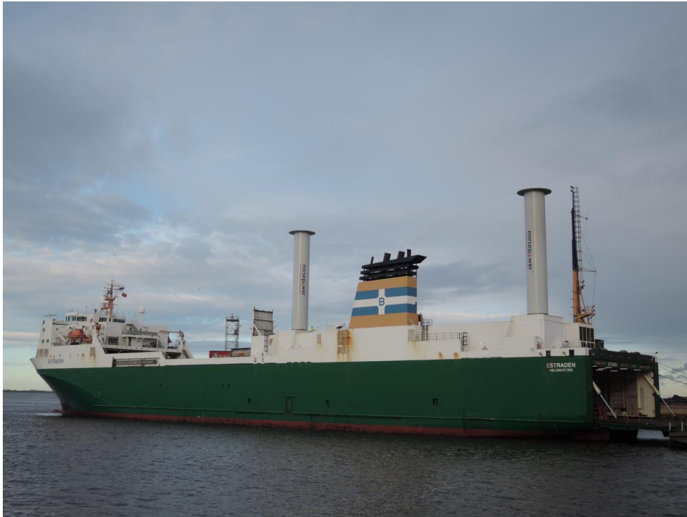
Kuva 1. M/V Estraden varustettuna kahdella roottoripurjeella. (1)
