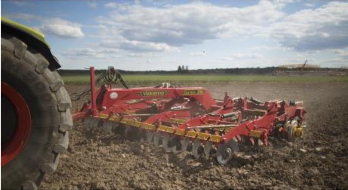
Bild 6. Tallriksharv är ett sätt att göra reducerad bearbetning, på bilden en Carrier 500 ( Väderstad Verken AB).
