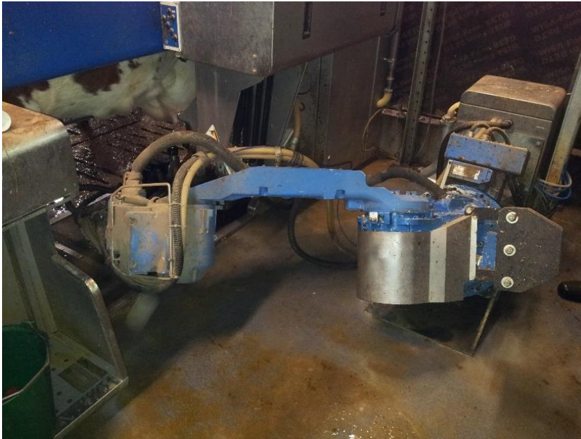
KUVA 5. Lypsyrobotti asettelee nännikuppeja vetimiin
