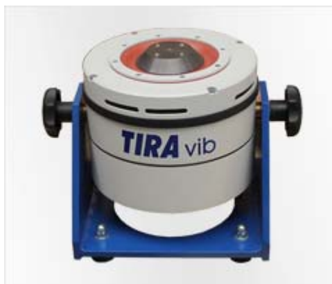
Kuva 6. TIRA S540-C tärinätestauslaite [16]
