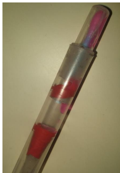
Kuva 15. Reagenssi-elvytysliuosseos valumassa kohti testinäytteen päätä kartion läpi.
