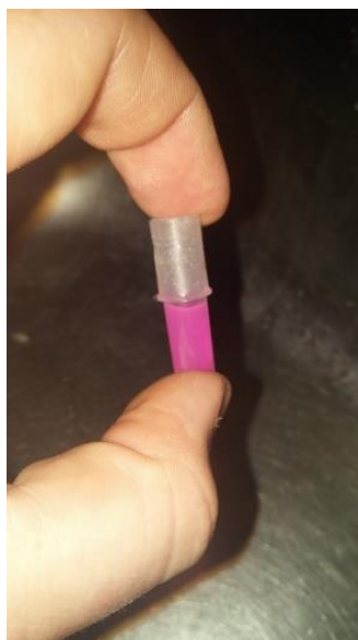
Kuva 13. Kontrollipään reagenssikapseli värjättyllä liuoksella.
