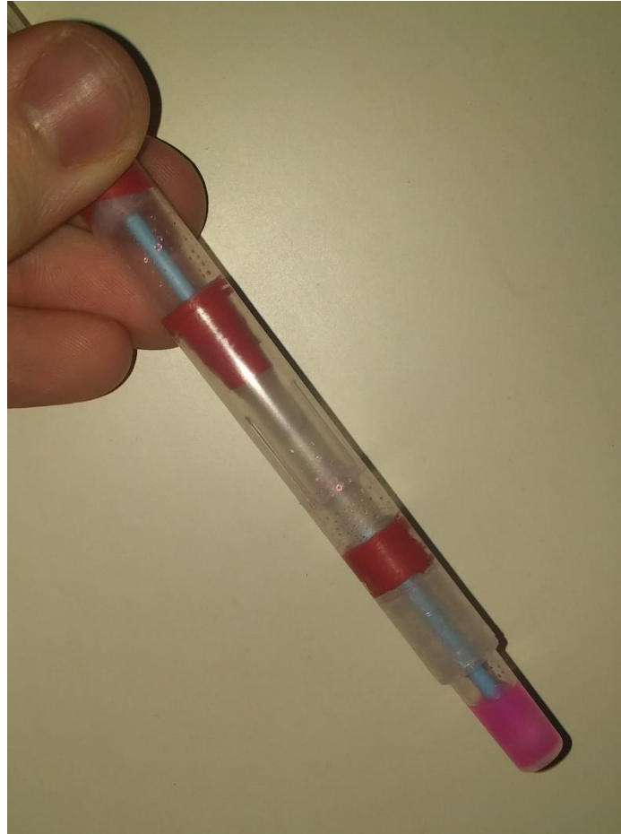
Kuva 16. Reagenssi-elvytysliuosseos testinäytteen päässä.
