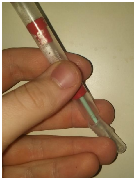
Kuva 12. Reagenssikapselin kiinnittäminen takaisin näytteenottopuikon suojaiksi.
