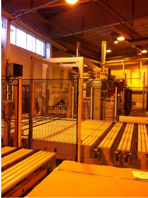
Kuva 4 Muovipakkauslinja ja linjalta valmistuneet paketit
