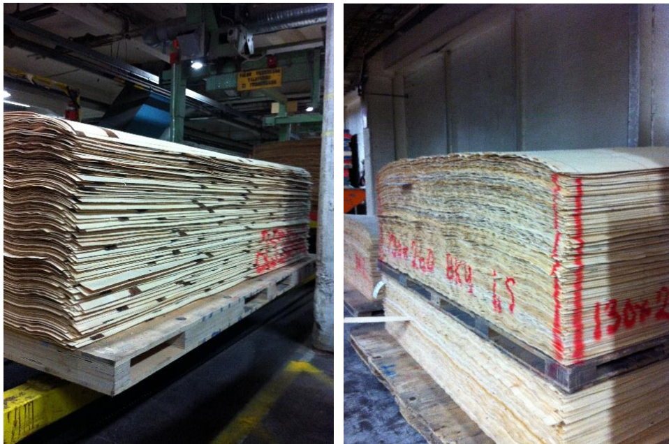
Kuva 7 Jatkettu ja saumattu viilukuorma
