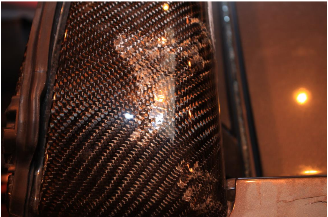
Kuva 7. Hiilikuituinen turvakaari ohjaamon ja moottoritilan välillä, lakkaus rikkoutunut.
