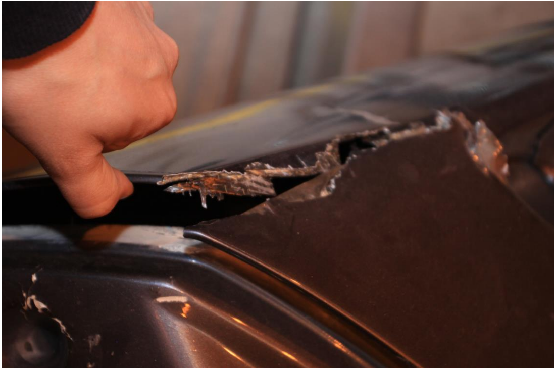
Kuva 6. Auton kuituosien repeämät. Kuvassa pahinten vaurioitunut kylkipaneeli.
