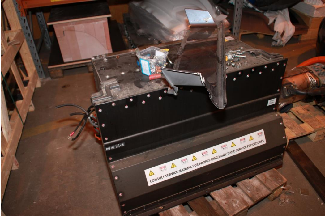
Kuva 3. Akkupaketti irrotettuna autosta.
