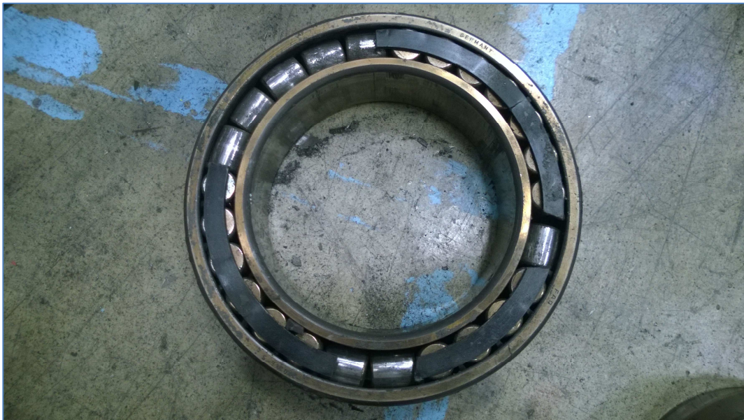
Kuva 6. Osa rullalaakerien rullista oli kääntynyt laakeripakan sisällä.
