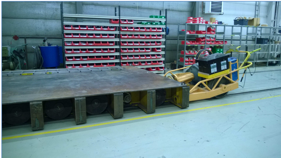
Kuva 1. Nykyinen kiskokuljetin. Ajolaite kytkettynä vetävään vaunuun.
