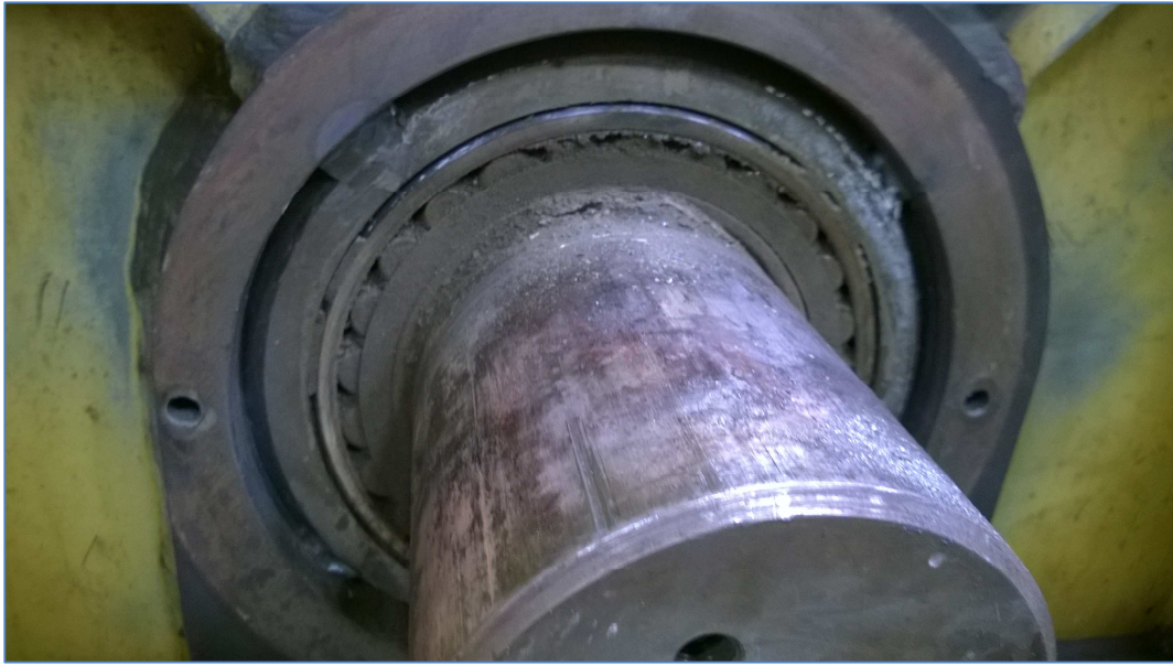
Kuva 5. Laakerirasvat olivat kuivaneet pölyksi kerosiinikuivauksessa.
