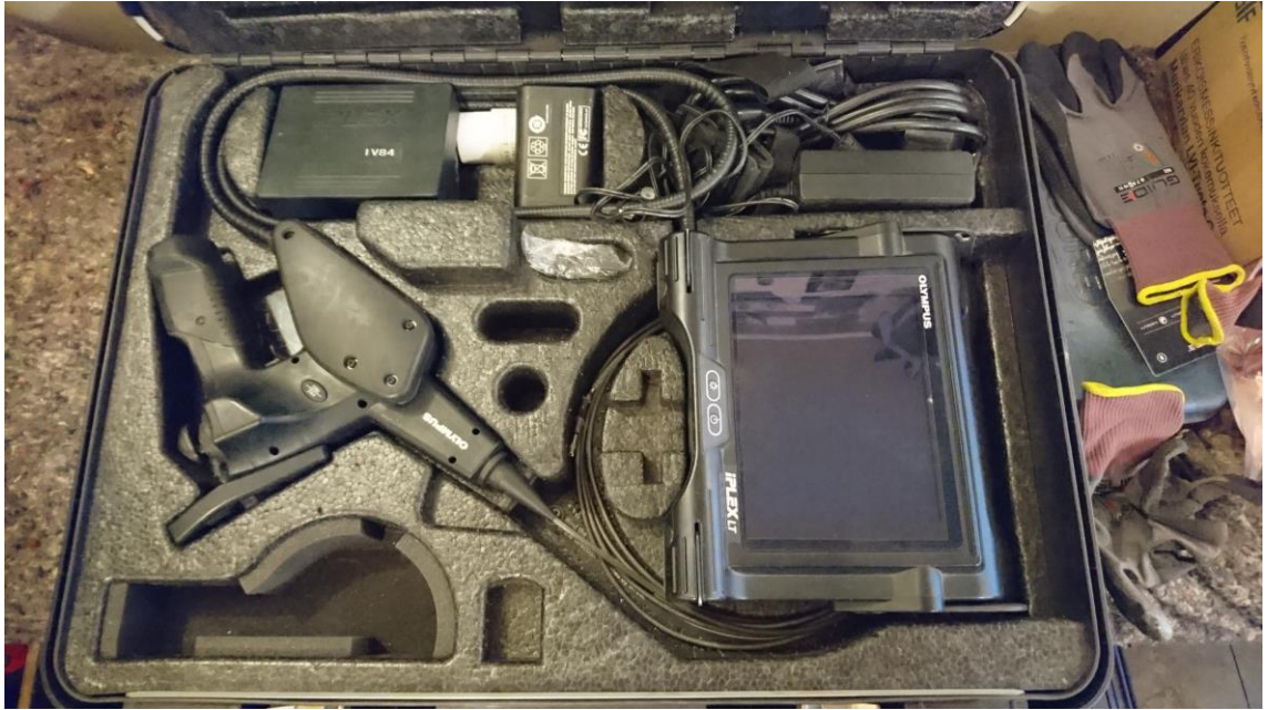
Kuva 15. Olympuksen valmistama vaijerikamera
