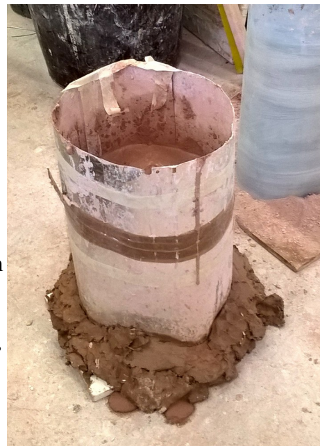
Kuva 3 Muottimassaa, melkein tarpeeksi. Tötterön pohja on tiivistetty savella.
