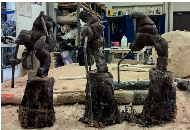
Kuva 8 Onnistunutkin valu näyttää ensin hurjalta, kun muottimassa on pesty pois.
