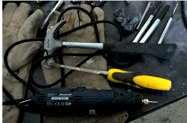
Kuva 9 Valun viimeistelyyn tarvittavia työvälineitä.
