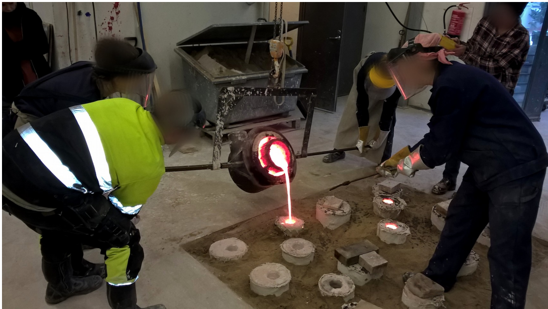
Kuva 7 Sulaa pronssia kaadetaan. Kaato vaatii monen ihmisen saumatonta yhteistyötä.
