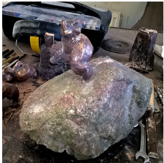
Kuva 14 Muotoilin valun tappia kunnes se sopi kokeilukiven reikään.
