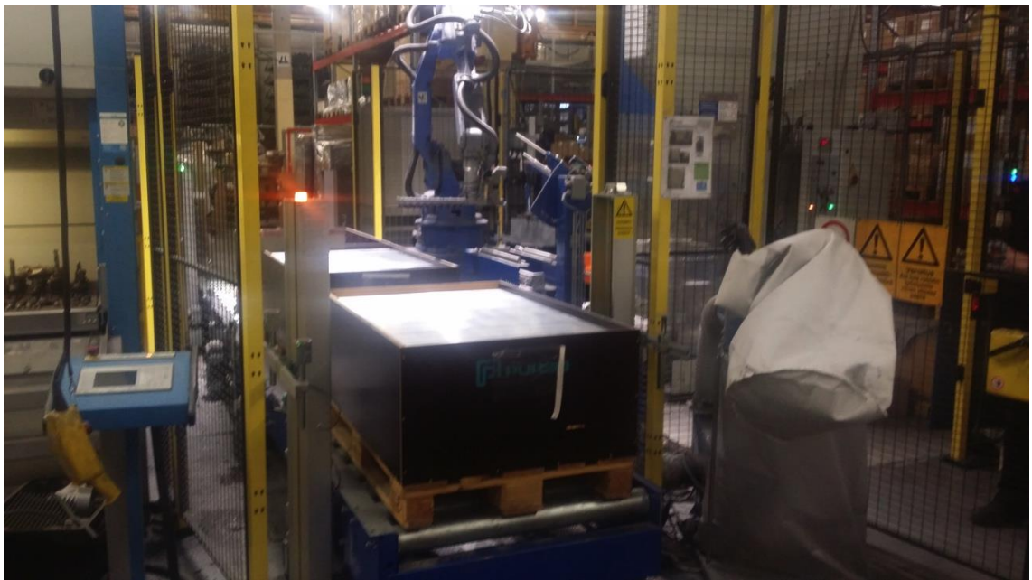
KUVA 1. Robottisolun lavojen syöttöasema (Kuva: Jere Niemelä 2016)
