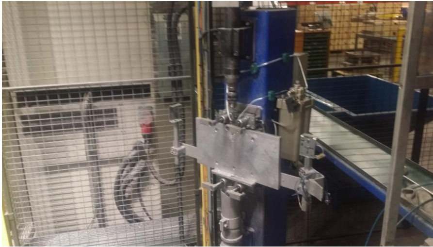
KUVA 5. Kierteytyspiste kiinnittimillä ja poralla (Kuva: Jere Niemelä 2016)
