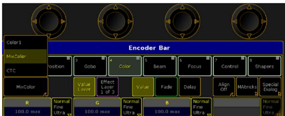
Kuva 8. Mac Viperia ohjattaessa GrandMA2 antaa Color-preset-typessä hallittavaksi kolme eri attribuuttia. Käsillä oleva värimiksaus vaatii käyttöönsä kolme fyysistä rullaa. (Kuva: Esko Ansami)
