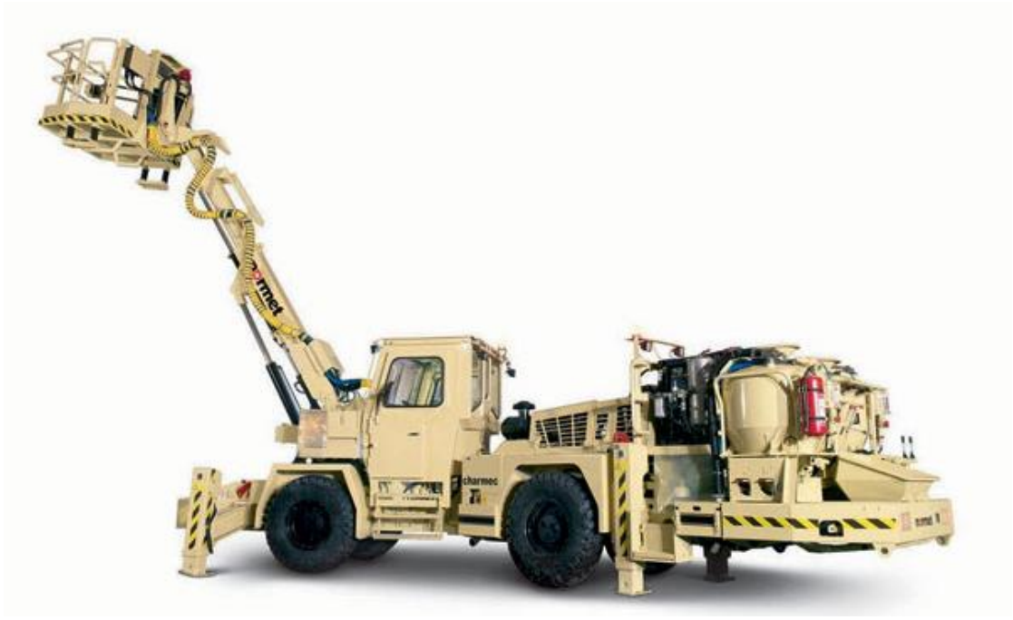
Kuvio 1. Normet Charmec MC 605 DA -tyyppinen Anfo-panostuslaite (Normet Group Oy 2015.)
