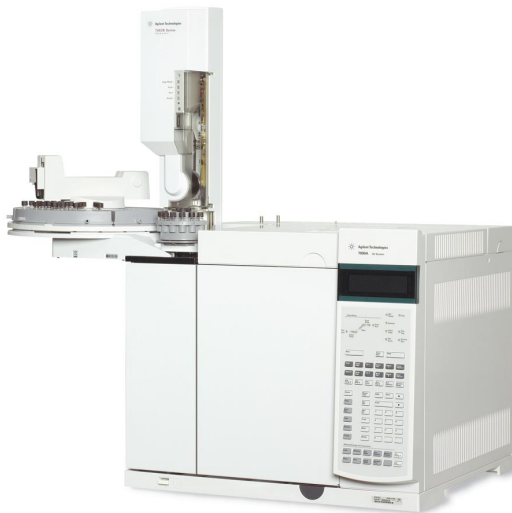
Kuva 5. Agilent 7890A -kaasukromatografi [15].
