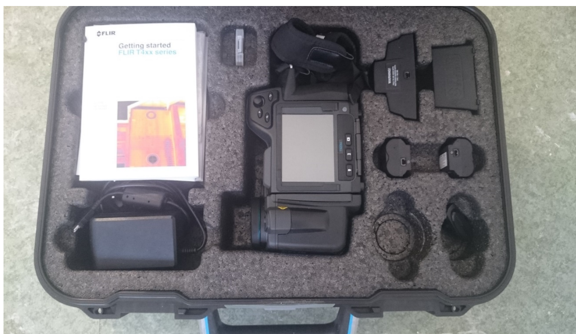
KUVA 11. Mittauksissa käytetty lämpökamera, Flir T4-series (Haapakorpi, 2016)
