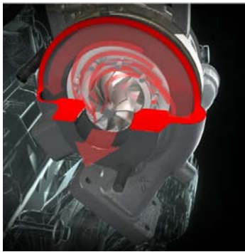
KUVA 4 VGT-ahdin läpät kiinni (JCB Trainin material 2015)
