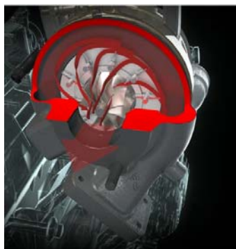
KUVA 5 VGT-ahdin läpät auki (JCB Training material 2015)
