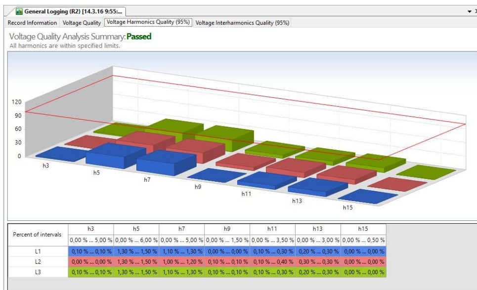
Kuva 19. PK 21-jänniteylijäätojen testin läpipääsy.
