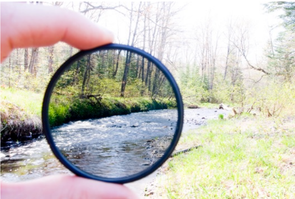
KUVIO 11. Harmaasuotimen toiminta demonstroituna (Wikimedia Foundation, 2016)
