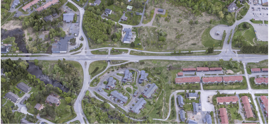
Kuva 21. Maantie 130 liittymien parantaminen välillä Kuljun kartano – Kiimakalliontie. Hanke 1 ja 2, kaksi liittymän parannusta. Kuvassa vasemmalla olevan risteyksen kohdalle tulee kiertoliittymä ja oikealla olevaa liittymää parannetaan.
