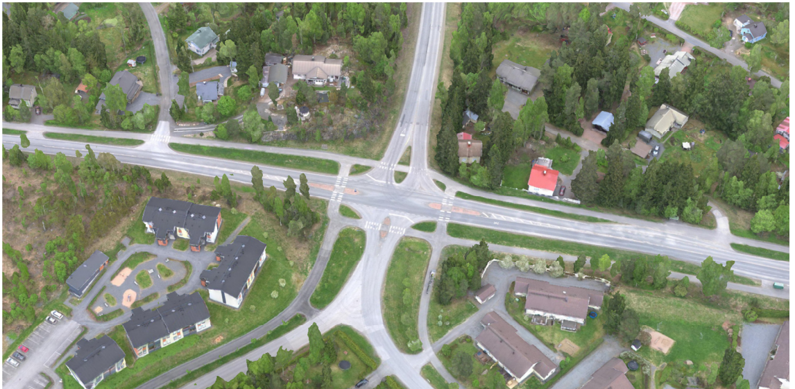
Kuva 22. Maantien 3003 parantaminen välillä Keskuskatu - Pysäkkitie. Hanke 3, liittymän parantaminen. Risteyksen tilalle tulee kiertoliittymä.
