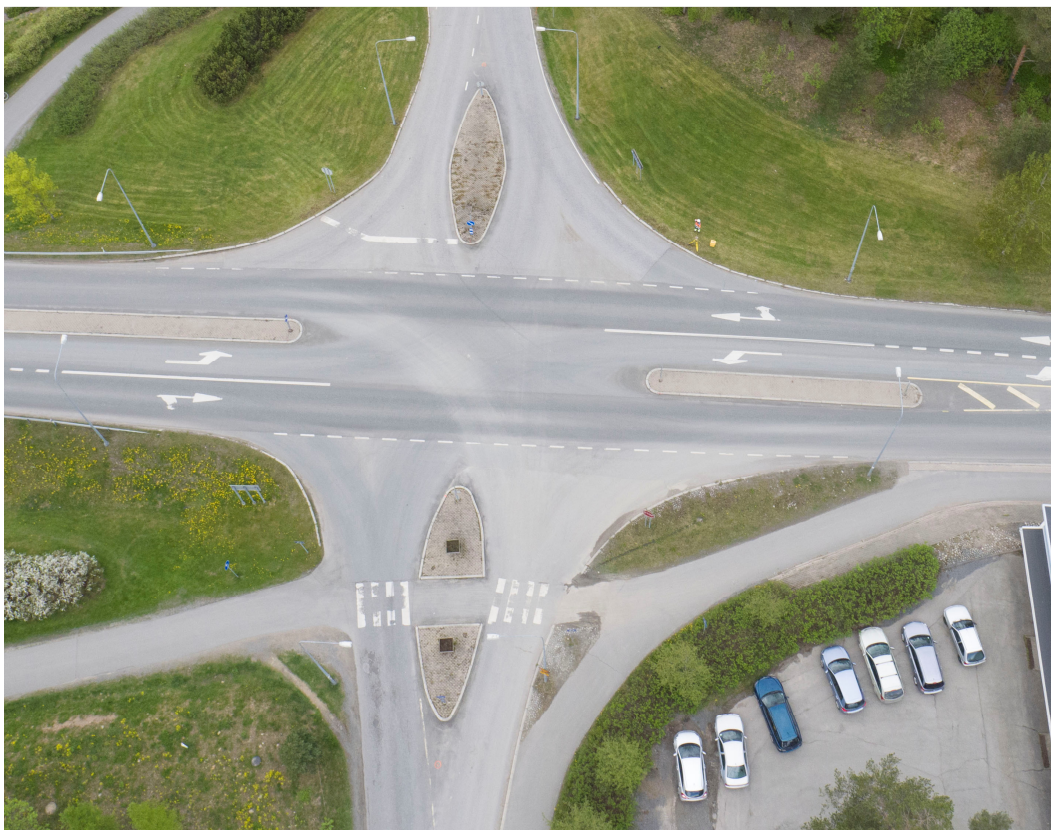
Kuva 20. Lempäälän kontrollipisteinä toimi pinkki asfalttiin maalattu ympyrä, jonka keskellä oli piste. Kuvasta erottaa haalealla alimman saarekkeen alareunasta sekä ylimmän saarekkeen yläreunasta kontrollipisteet. Kontrollipisteenä voi toimia myös puusta tehty rasti maastossa, mikäli kontrollipisteitä ei voi maalata.
