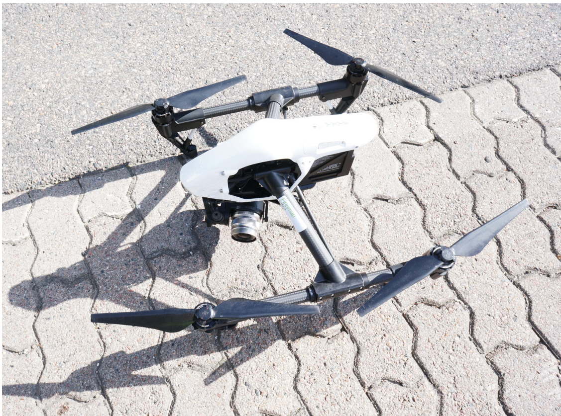
Kuva 16. Koptereiden etu on, että niille riittää pieni alue nousuun ja laskeutumiseen. Kuvassa DJI Inspire, josta jalustat saa nostettua ylös pois kameran tieltä kun kopteri on noussut ilmaan. [26, s.32.]
